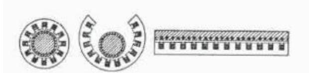
**Fig. 1:** Transformación tipológica de un motor de inducción rotativo en un motor lineal plano.
