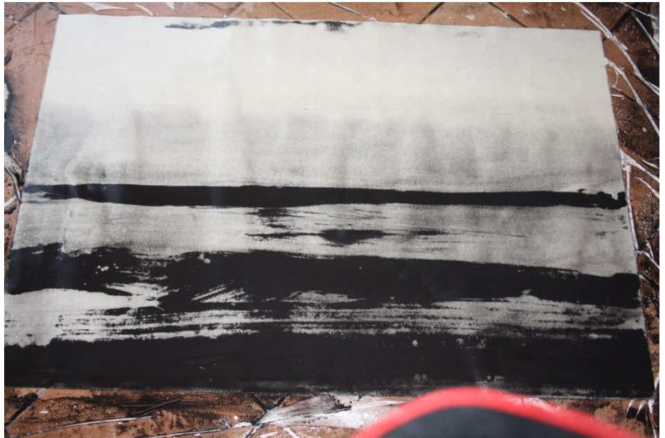
Papel pintado después de la acción del lavado mediante agua a presión
