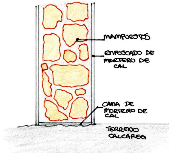
Figura 75 Detalle cimentación
