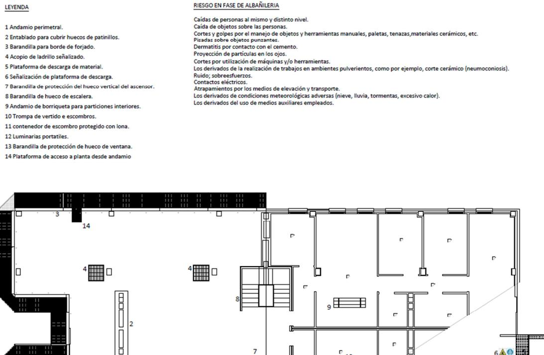
Figura 3.36. Recorte de plano de albañilería donde se respeta un orden y organización según las 5”s”
