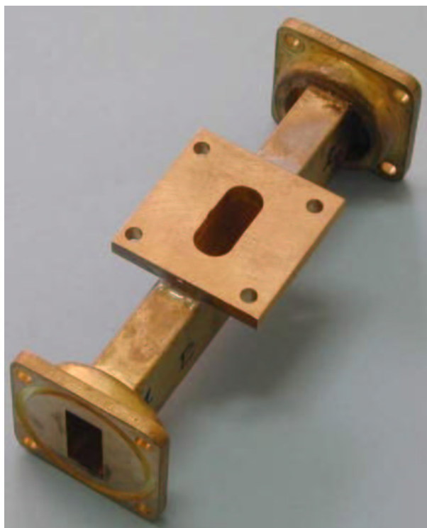
Figura 4.13. Unión T en plano H en guía WR-90 con acceso lateral redondeado con un radio de curvatura de 4,5 mm.
