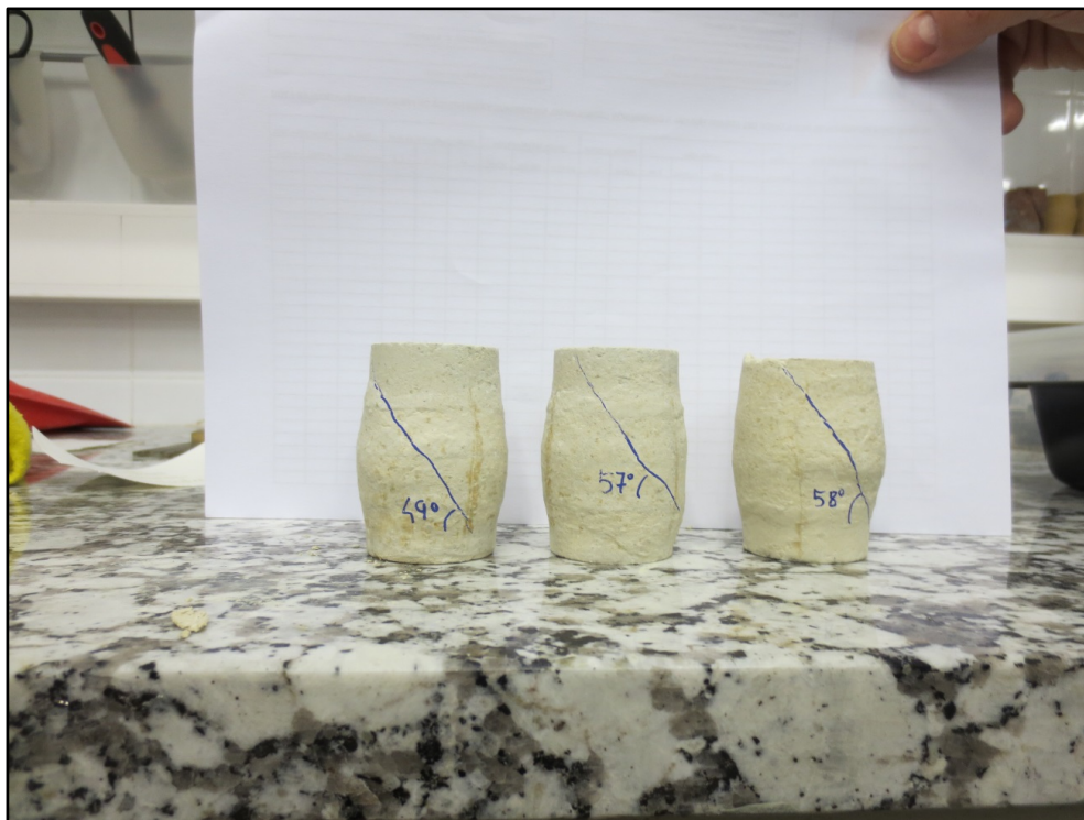
Figura 7.3.38. Probetas una vez finalizado el ensayo triaxial y determinación del ángulo del plano de rotura. DIT14-1001.
