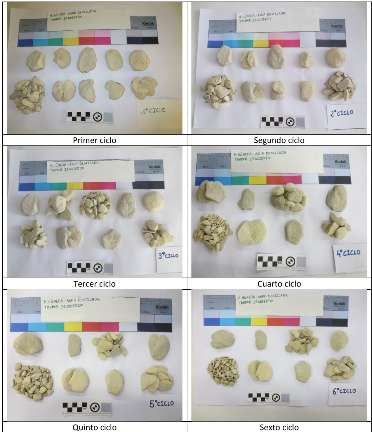
Figura 7.5.16. Aspecto de la muestra tras sucesivos ciclos del Slake. DIT14-601. Variante 5.
