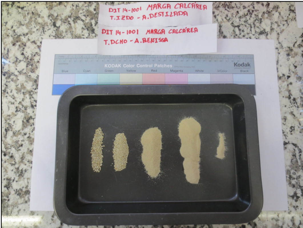
Figura 7.2.21. Distribución granulométrica de la muestra de marga calcárea. DIT14-1001.
