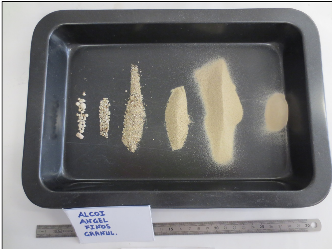
Figura 7.2.9. Distribución granulométrica de la Muestra 1 de Alcoy. DIT14-201.
