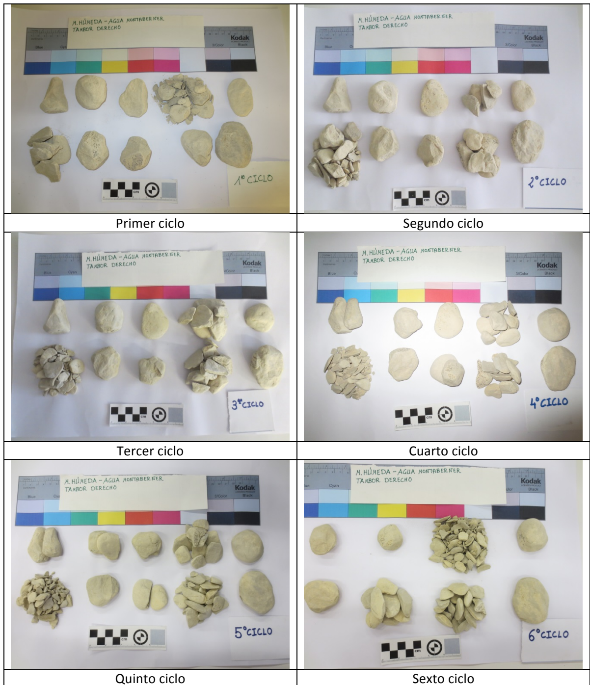
Figura 7.5.20. Evolución del aspecto de la muestra tras los sucesivos ciclos del ensayo. DIT14-601. Variante 6.
