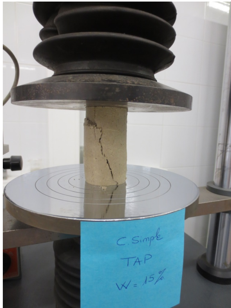
Figura 5.2.98. Rotura de la probeta.
