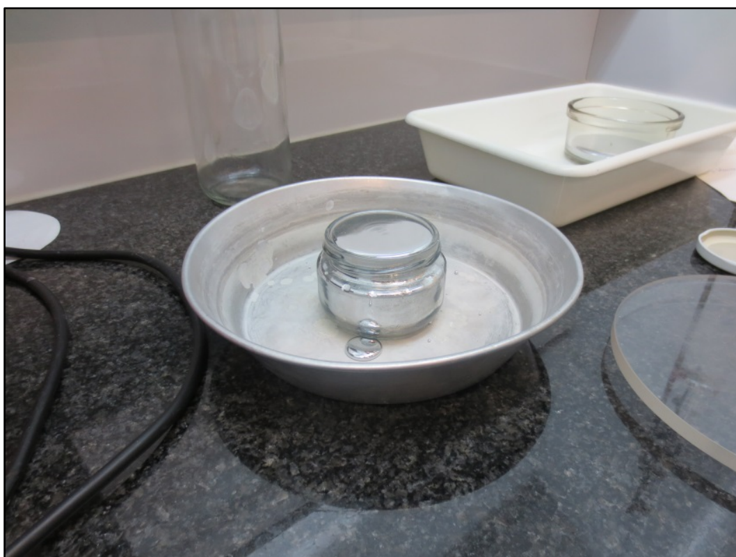
Figura 5.2.70. Mercurio desplazado por la pastilla de suelo.
