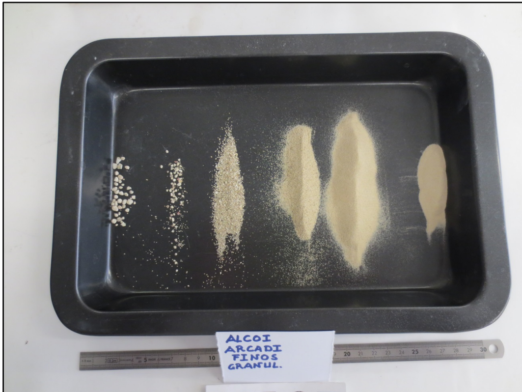
Figura 7.2.11. Distribución granulométrica de la Muestra 2 de Alcoy. DIT14-201.
