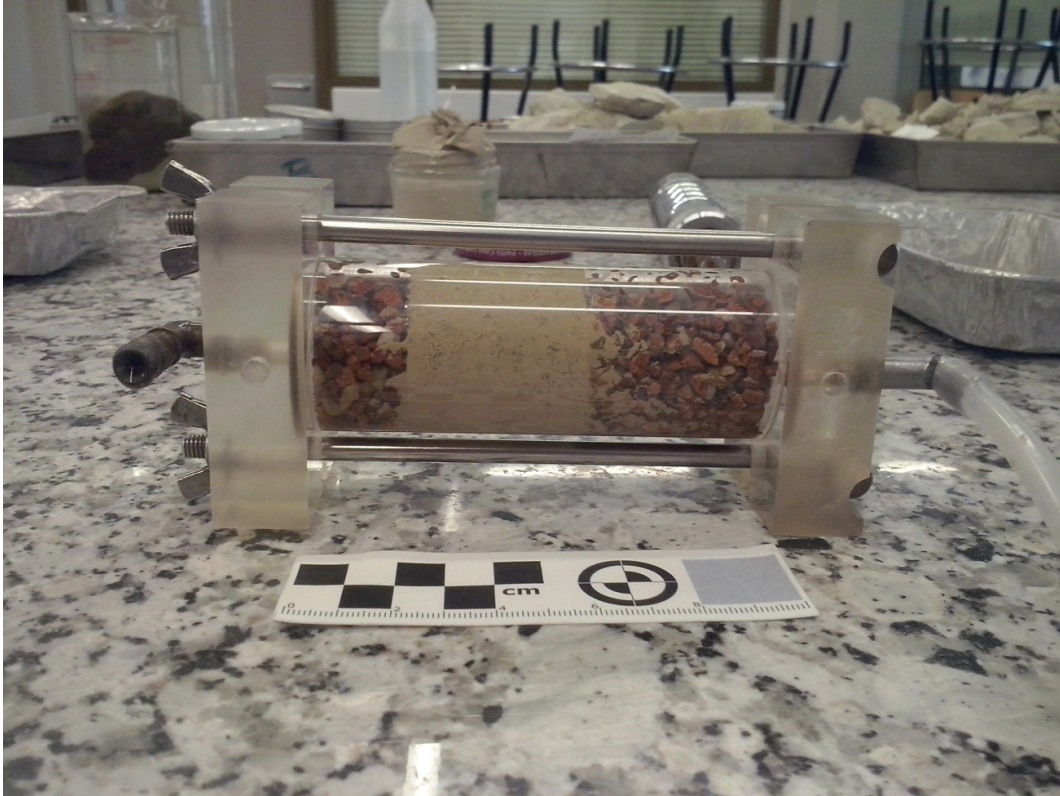
Figura 5.2.89. Aspecto de la probeta en el molde Sherar una vez finalizado el ensayo.
