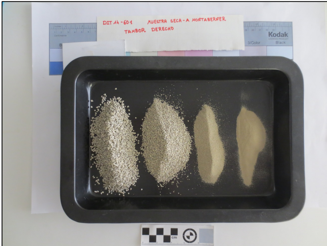
Figura 7.2.17. Distribución granulométrica de la muestra Slake- Agua de Montaberner. DIT14-601.
