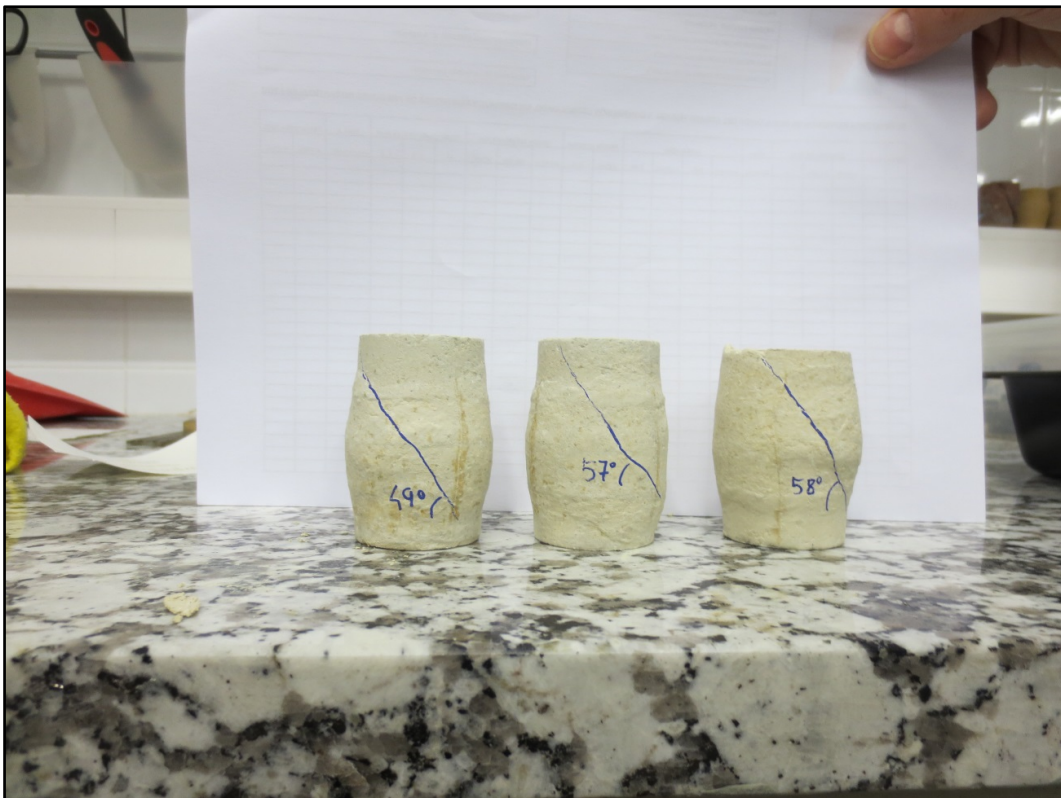
Figura 5.2.145. Aspecto de las probetas tras finalizar el ensayo triaxial.
