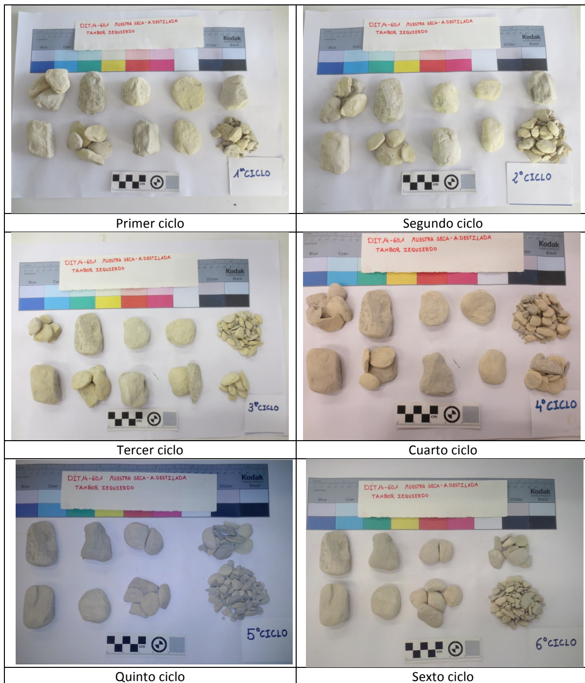
Figura 7.5.24. Evolución del aspecto de la muestra con los sucesivos ciclos del ensayo. DIT14-601. Variante 7.
