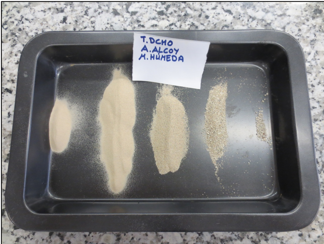
Figura 7.2.13. Distribución granulométrica de la muestra Slake-Agua de Alcoy. DIT14-201.
