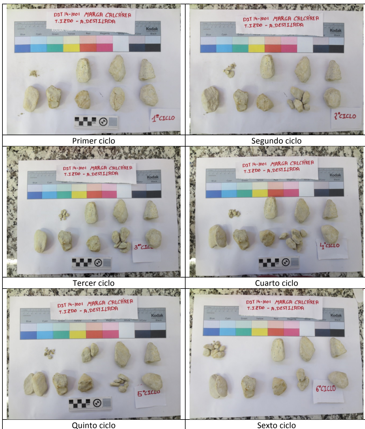
Figura 7.5.39. Evolución del aspecto de la muestra con los sucesivos ciclos. DIT14-1001. Variante 11.
