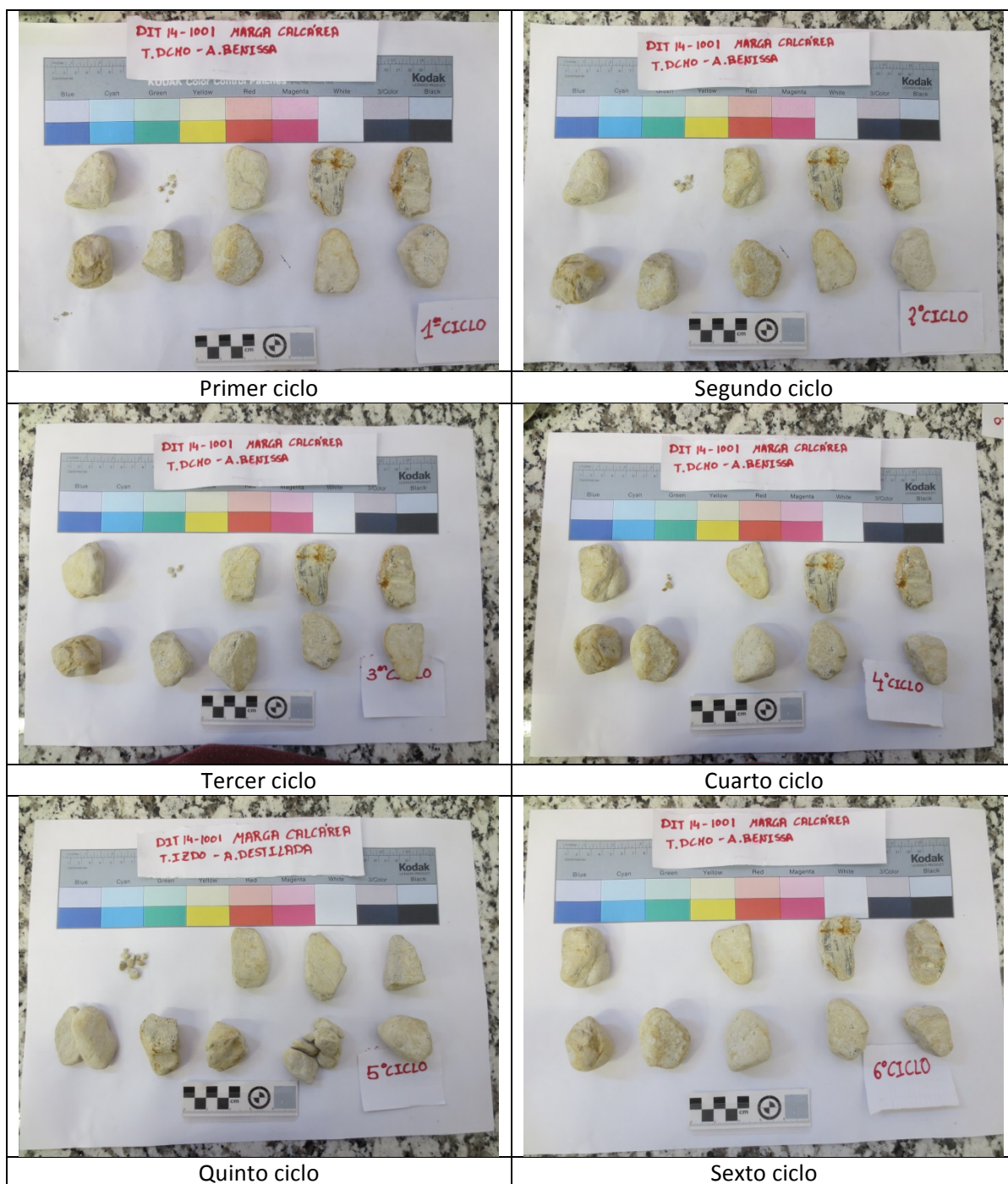
Figura 7.5.43. Evolución del aspecto de las muestras con los sucesivos ciclos. DIT14-1001. Variante 12.
