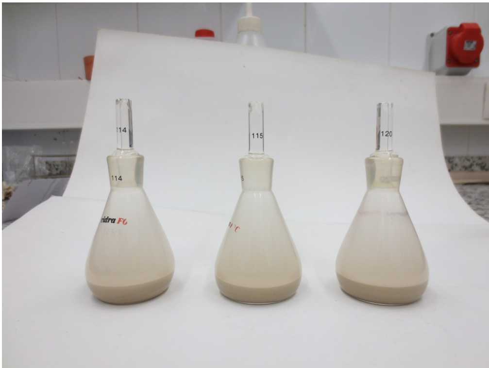
Figura 5.2.60. Aspecto de los picnómetros al finalizar el ensayo.
