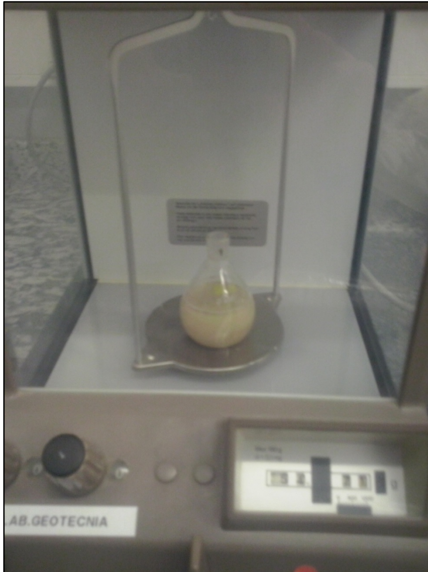
Figura 5.2.132. Determinación de la masa del picnómetro, sin cuello y lleno de agua hasta la mitad más la muestra.
