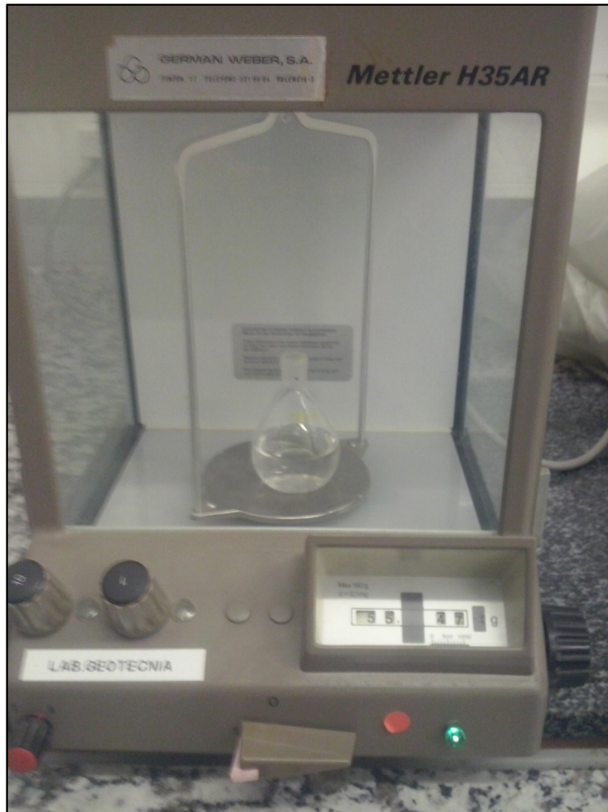
Figura 5.2.131. Determinación de la masa del picnómetro sin cuello lleno de agua hasta la mitad.
