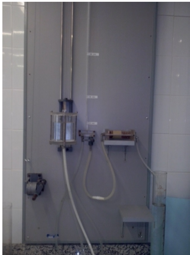
Figura 5.2.87. Conexión de depósito con el molde Sherard.
