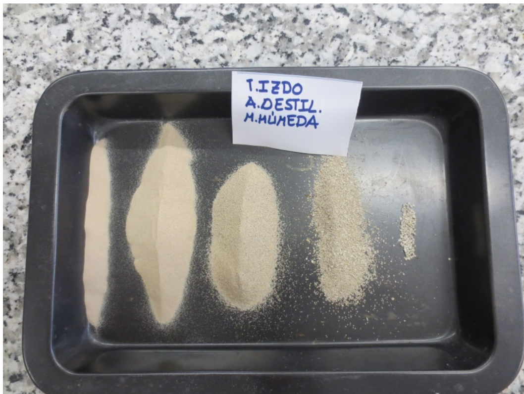
Figura 5.2.125. Distribución por tamaño de los materiales depositados en la cubeta.
