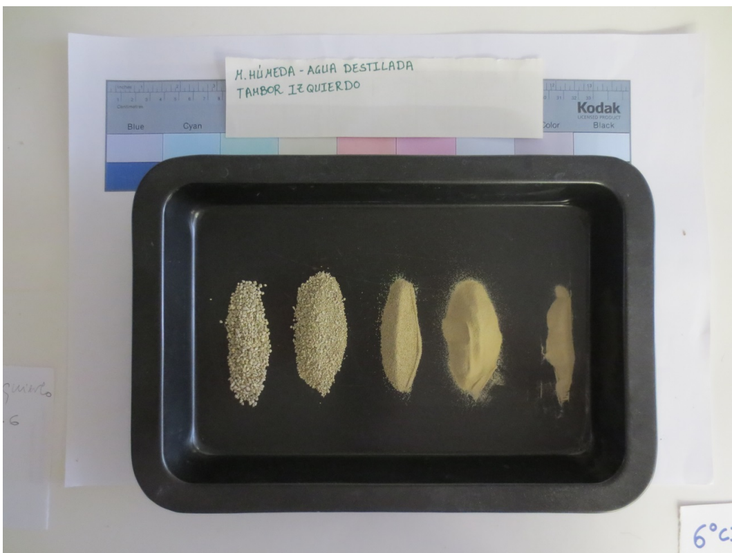
Figura 5.2.51. Distribución granulométrica del material depositado en la cubeta.
