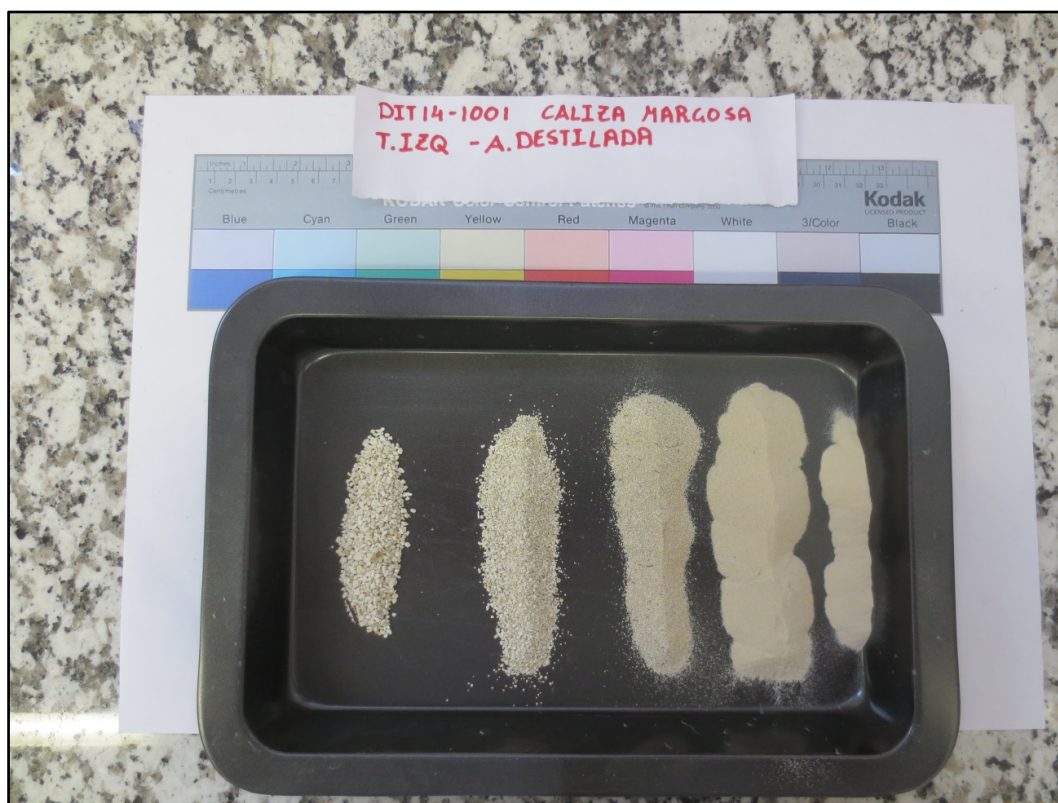
Figura 7.2.23. Distribución granulométrica de la muestra de caliza margosa. DIT14.1001.
