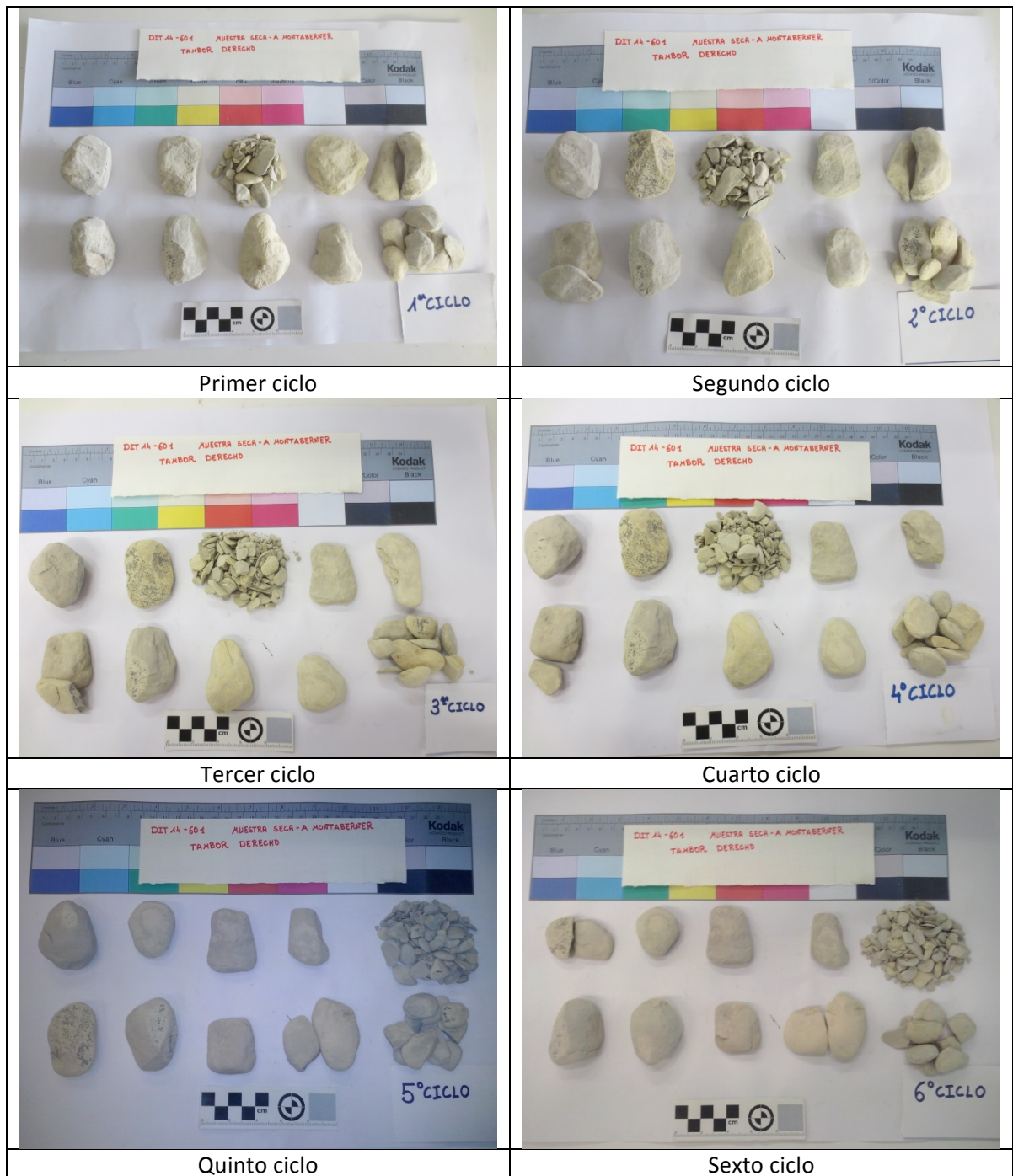
Figura 7.5.27. Evolución del aspecto de la muestra con los sucesivos ciclos del ensayo. DIT14-601. Variante 8.
