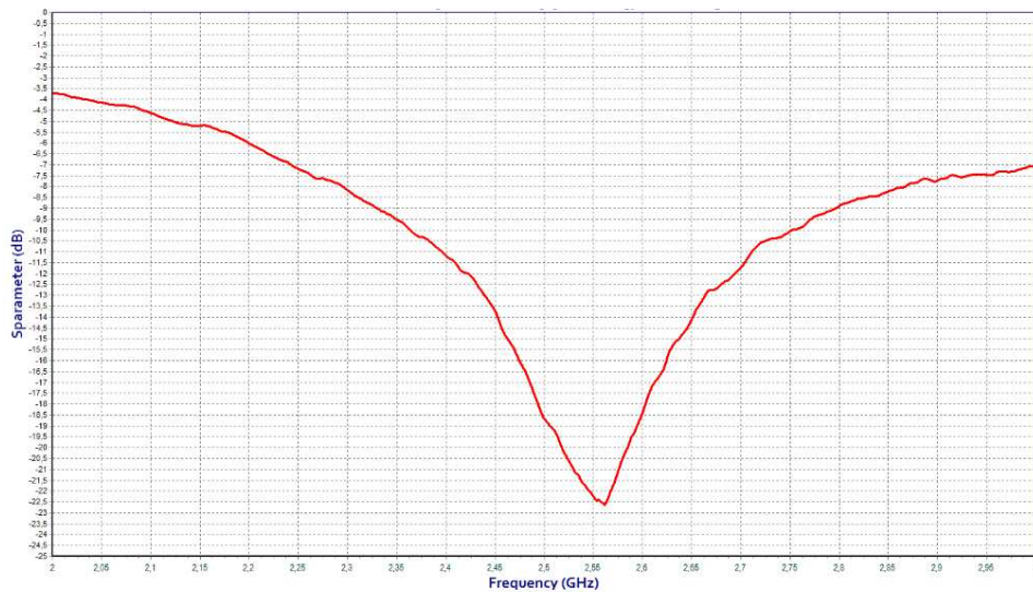
Figura 4.12 Medida del monopolo construido sin circuito rectificador.
