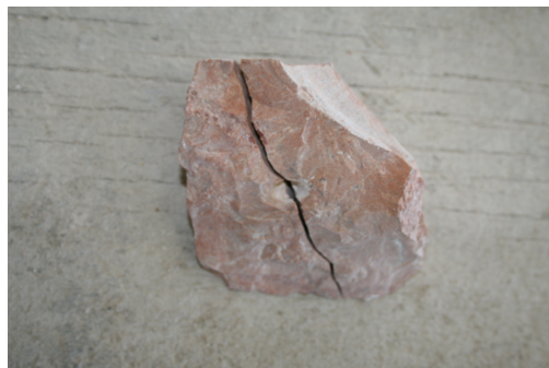
Fig. 56 Piedra rota tras el intento de perforarla
