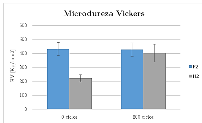
Figura 4.3. Resultados de la microdureza de las muestras F2 y H2 a 0 y a 200 ciclos térmicos.
