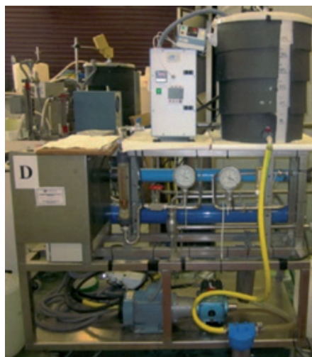
Figura 3: Disposición de los módulos de membrana en la planta piloto para ensayos experimentales de OI
