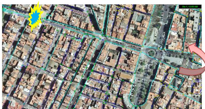
**Rotura Tubería Interconexión:** El sistema funcionaria correctamente hasta 4 días después, después el sector Eixample terminaría sin presión.
