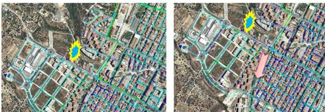
**Solución:** Abrir la tubería que separa los sectores Barri y Eixample, tal i como estaba configurado en 2013 antes de la puesta en funcionamiento del depósito
