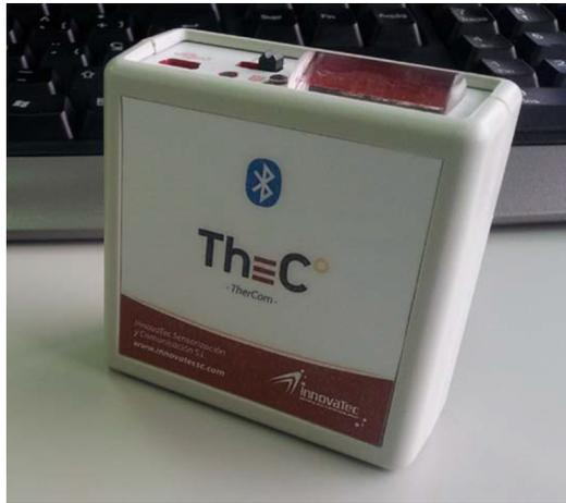
**Figura 3.4:** Termómetro clínico de medición continua *Thercom*<sup>©</sup>.
