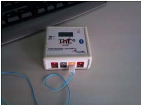
**Figura 3.7:** Entrada de la sonda de temperatura al canal D a *Thercom*®.
