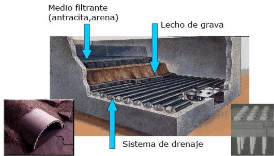
Figura 30: Esquema de un filtro de arena
