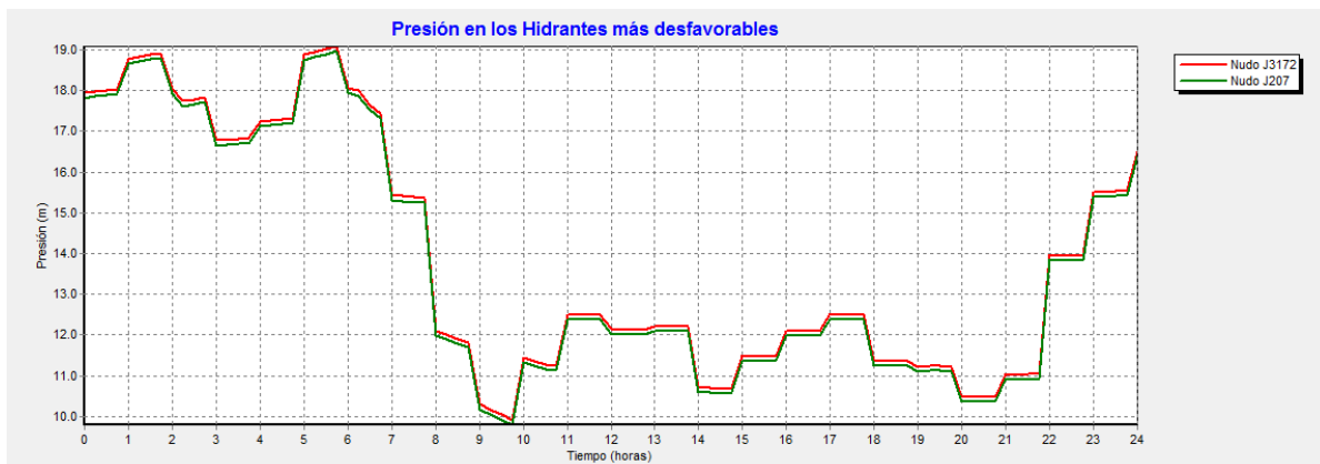
Figura 6-49. Presión en hidrantes cercanos en la zona más desfavorable cercana al Depósito Sepes
