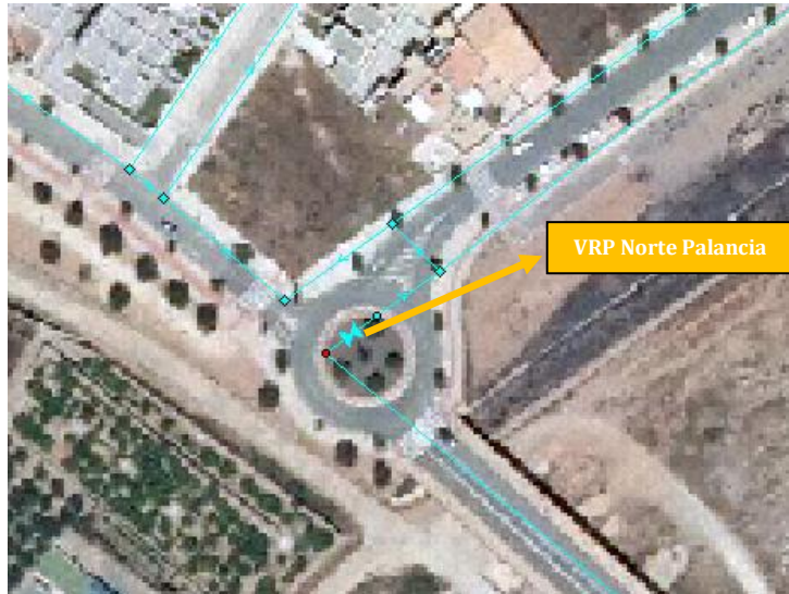
Figura 7-4. Emplazamiento de la VRP a la entrada de Norte Palancia Primera rotonda de Norte Palancia a la salida del primer puente
