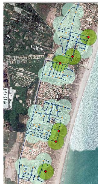
Figura 7-17. Hidrantes propuestos en L'Almardà Norte
