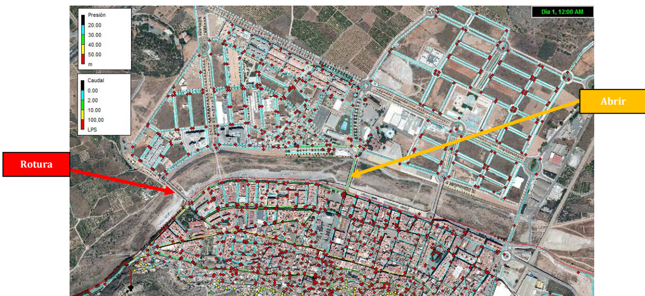
Figura 6-38. Solución a la rotura de la conducción que alimenta a Norte Palancia
