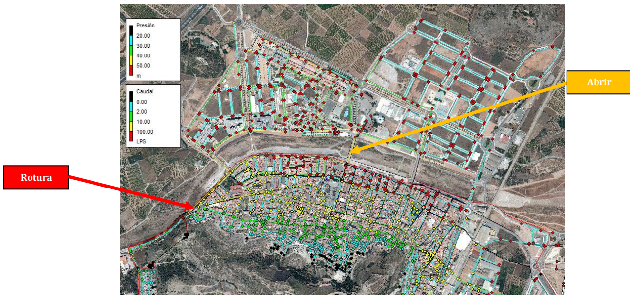
Figura 6-36. Solución a la rotura de la conducción que alimenta a Sagunto Centro Urbano
