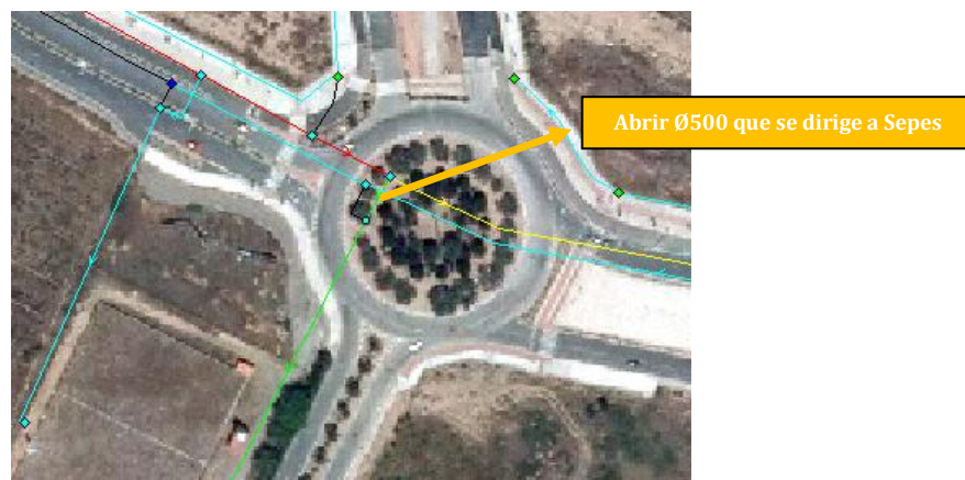
Figura 7-6. Apertura de conexión al Polígono Sepes por \varnothing 500 Rotonda de Sepes
