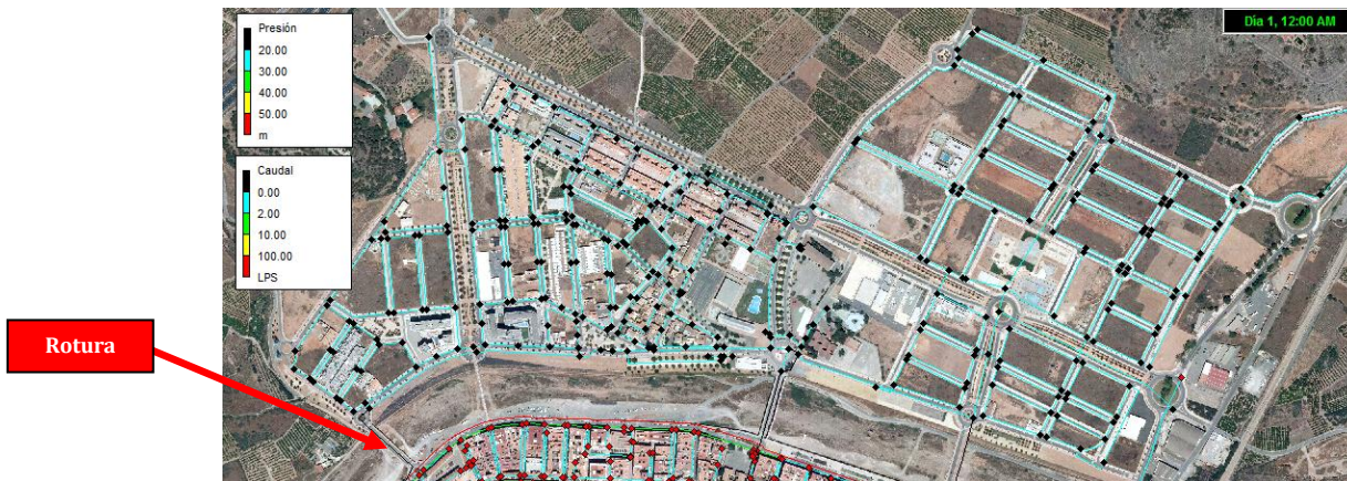
Figura 6-37. Rotura de la conducción que alimenta a Norte Palancia (Ø300)
