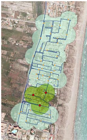
Figura 7-18. Hidrantes propuestos en L'Almardà Sur
