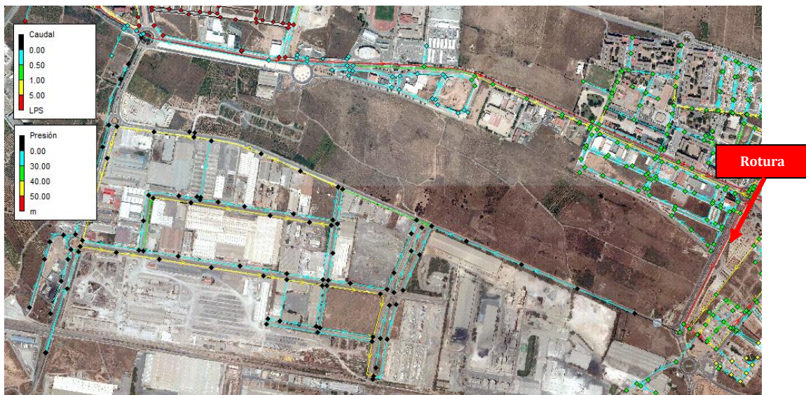
Figura 6-42. Rotura de la conducción que abastece a Polígono Sepes (Ø300)
