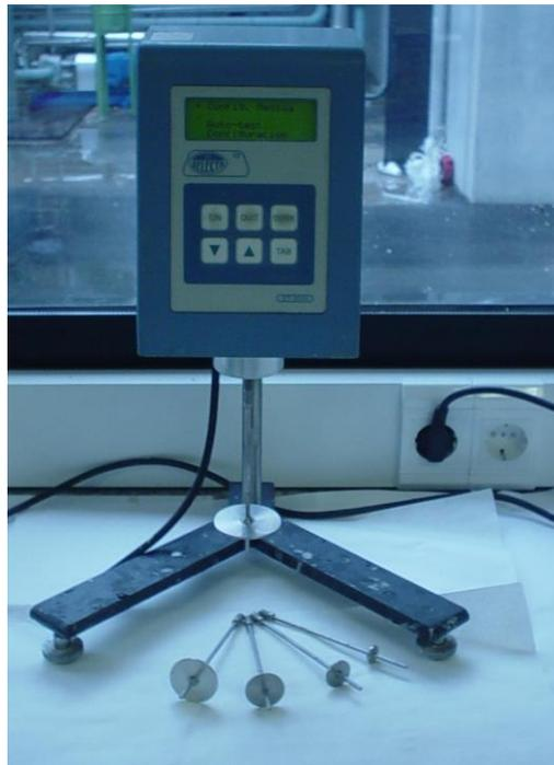
Para que las medidas sean correctas, las palas de los husillos no deben tocar las paredes del recipiente a medir, y deben hundirse en la muestra hasta la hendidura que tienen, es decir, deben introducirse a 5 cm de profundidad, pero sin tocar el fondo del recipiente. Además, se debe tener en cuenta el porcentaje de error que aparece en la pantalla mientras se realiza la medición, ya que para que la lectura sea correcta debe encontrarse entre el 30% y el 70%.
