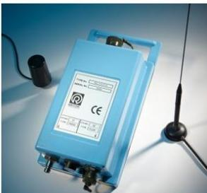
Para solventar un posible problema de suministro de energía en determinados momentos o en puntos singulares, el sistema podría funcionar con baterías, transmitiendo datos en caso de alarma o a intervalos programados.
