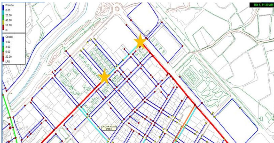
Figura 119. Situación del sistema (1.000 l/min) ante un incendio en Aspe.
