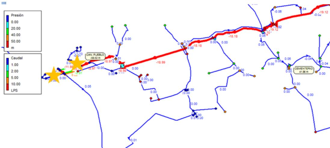
Figura 123. Situación de incendio (500l/min) en La Canalosa.
