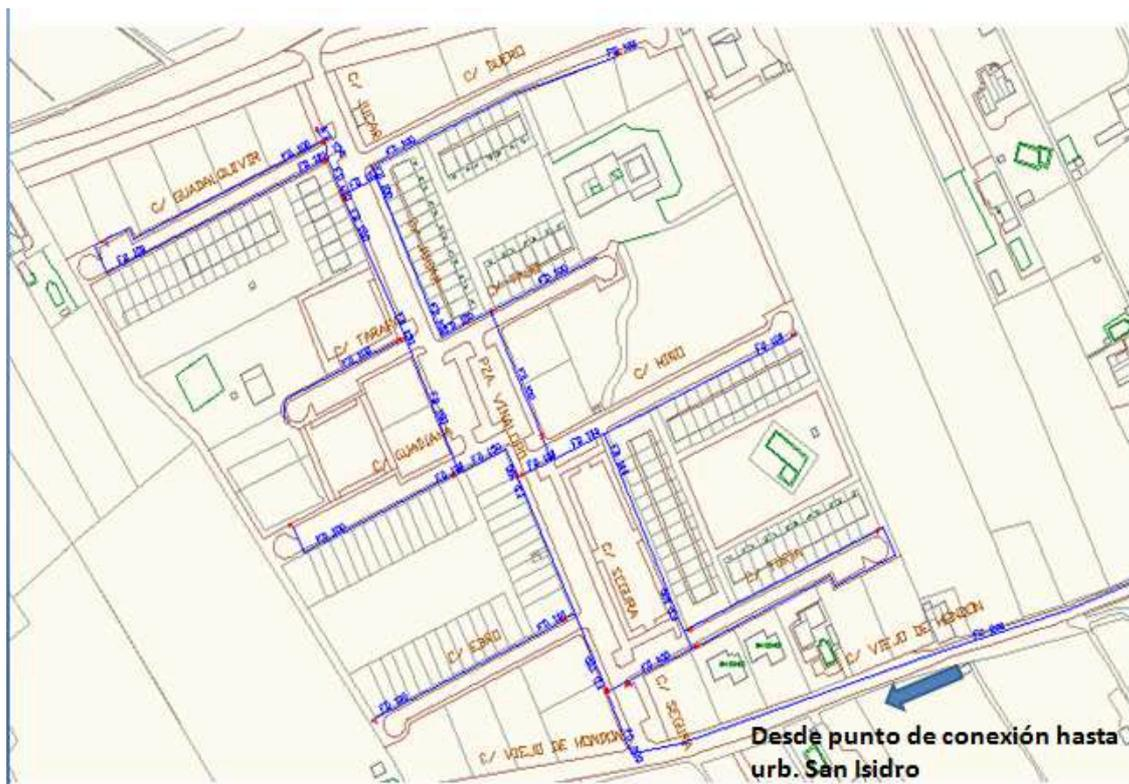
Figura 4 Imágen de la red de tuberías en la urbanización San Isidro.
