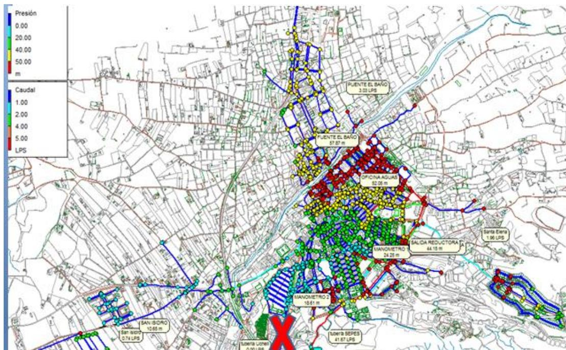
Figura 116. Rotura de la tubería que viene desde el depósito de Uchell y abastece al casco urbano de Aspe.
