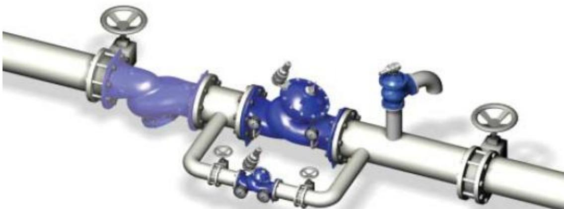
Figura 148. Instalación en paralelo de la VRPs a la entrada del sector
