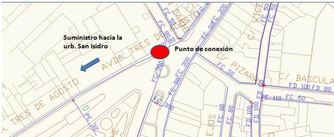
Figura 3 Imágen de la conexión para el suministro de la urbanización San Isidro.
