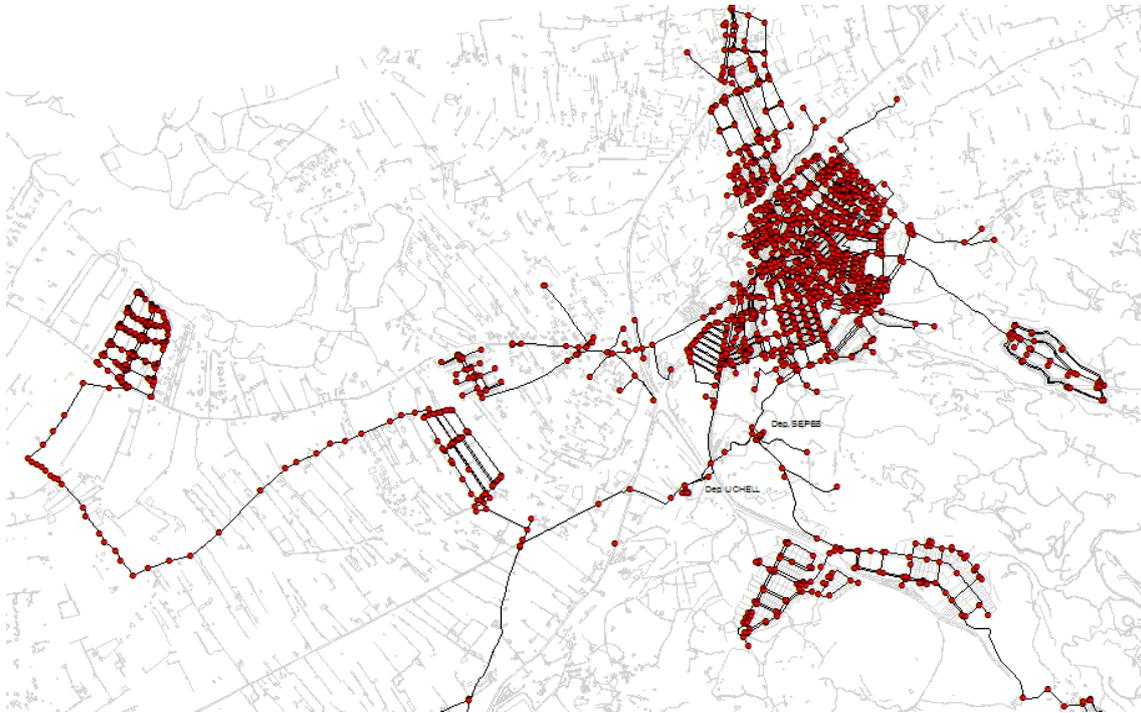
Figura 8 Esquema general del sistema detallando puntos de consumo o conexión y tuberías en GisRED.
