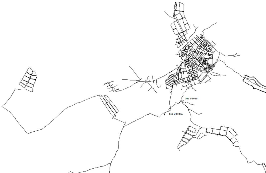
Figura 5 .Vista general de la esqueletización del sistema de Aspe.
