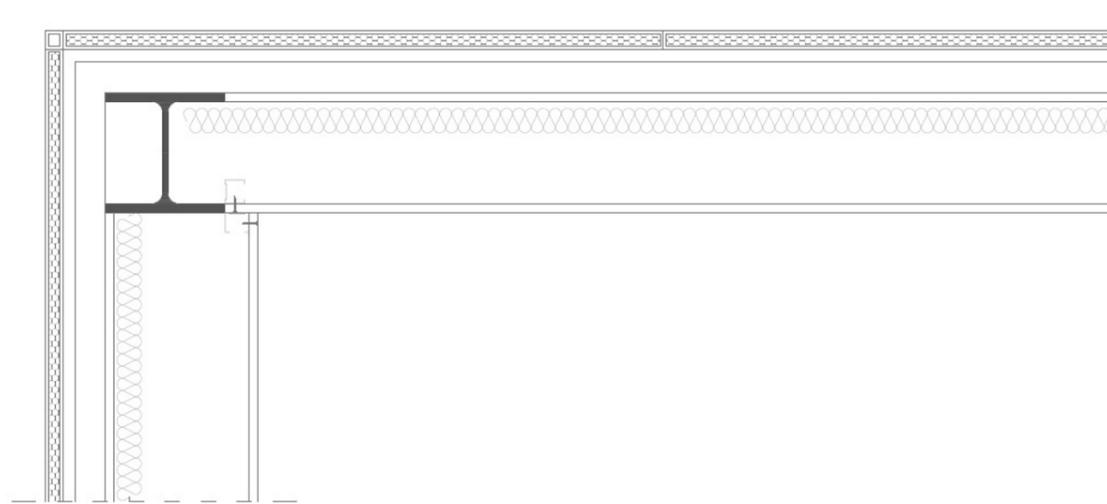
Lo primero será calcular la resistencia térmica. Para ello debemos obtener la resistencia superficie exterior Rse y la resistencia superficial interior Rsi.
