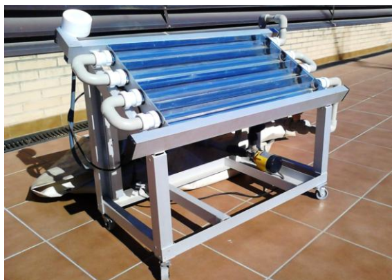
Figura 4.2.4.- Planta piloto de fotocatalisis solar de 4 L.
