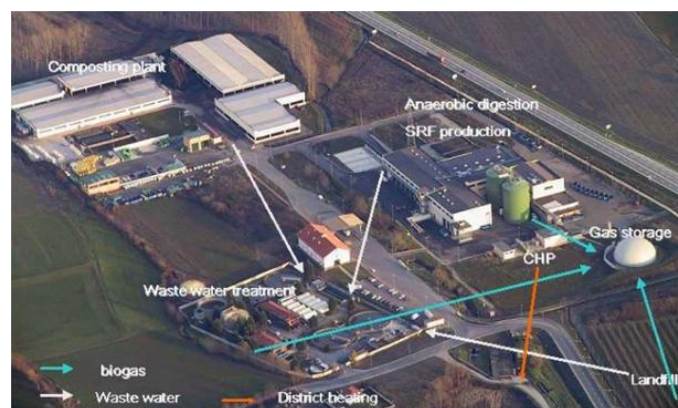
Figura 1.2.1.- Planta ACEA Pinerolese. Las flechas indican el flujo de energía y material a lo largo de las cuatro secciones de la planta: compostaje, digestión anaeróbica, tratamiento de aguas y vertedero (Arques A. et al. 2015).
