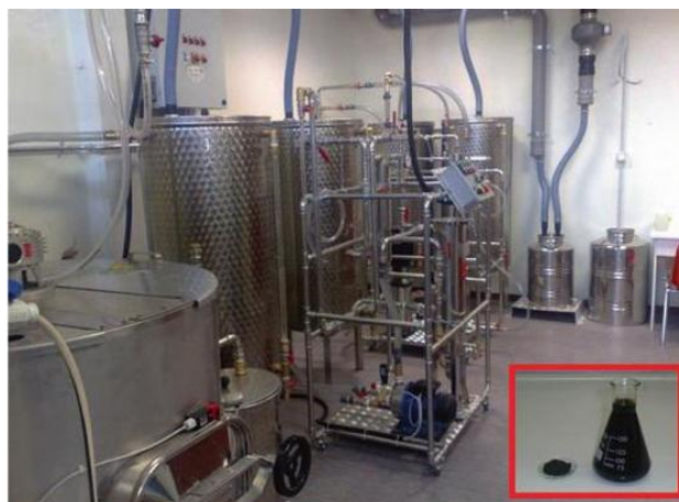
Figura 4.1.10.- Planta piloto para la obtención de SBO. Imagen incrustada: SBO en polvo y su disolución en agua (Arques A. et al. 2015).
