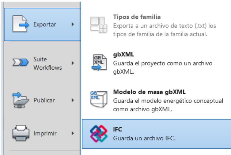
Ilustración 8: Interfaz Revit 2014. Formato IFC. Fuente propia.
