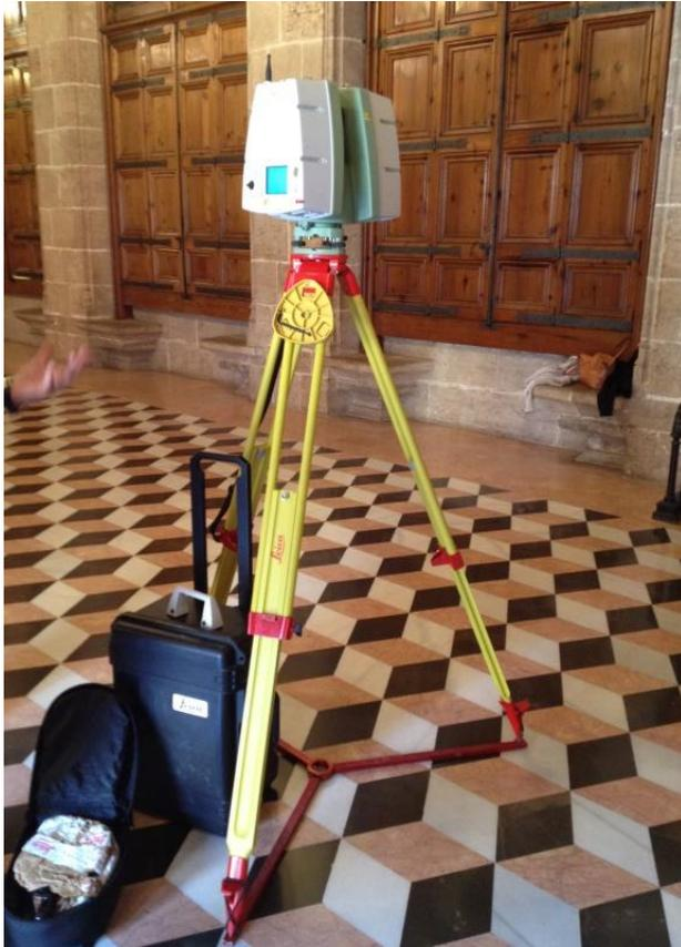
*Ilustración 15: Estacionamiento del escáner láser 3D en la Lonja de València.
