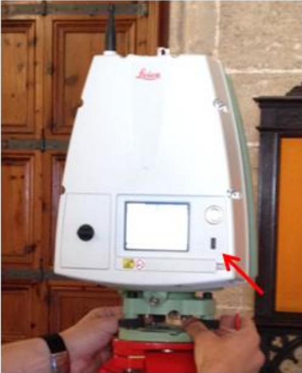
*Ilustración 39: Puerto USB del escáner láser 3D.
