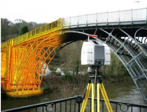
*Ilustración 18: Escaneado puente metálico.*
