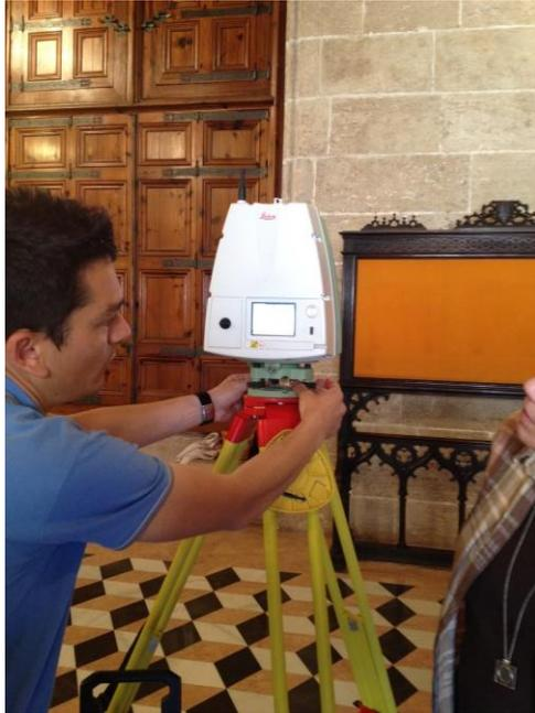
*Ilustración 38: Técnico de Leica explicando cómo aplomar el escáner.
