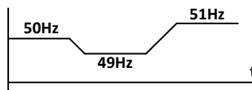
Figura 112: Perfil de variación de la frecuencia de la microrred
