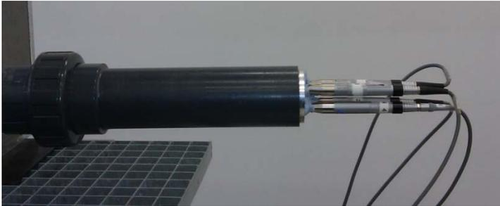
Figura 4.14. Montaje para la calibración de micrófonos.
