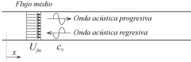
Figura 2.3. Componente progresiva y regresiva de presión en conducto con flujo medio.
