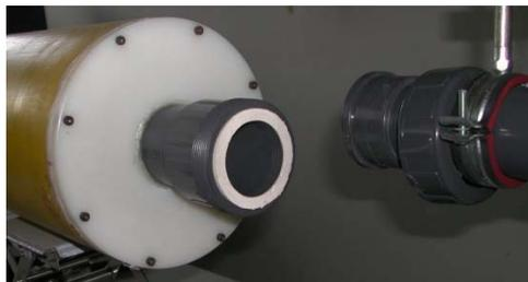
*Figura 4.10. Anillo de silicona entre conductos.*
