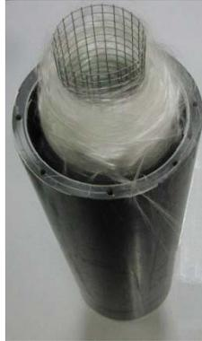
*Figura 4.58. Construcción de la cámara 3 disipativa.*
