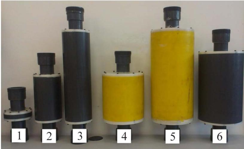
*Figura 4.34. Prototipos de silenciadores ensayados.*
