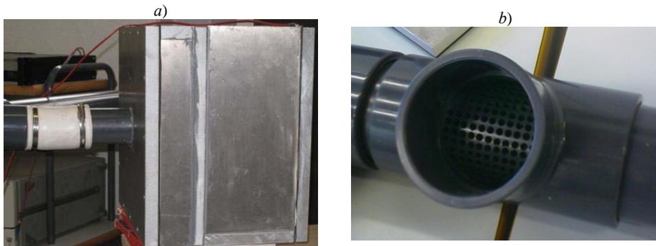
Figura 4.11. Detalles del dispositivo experimental implementado: a) Caja de altavoz y junta flexible; b) Conexión a línea principal.
