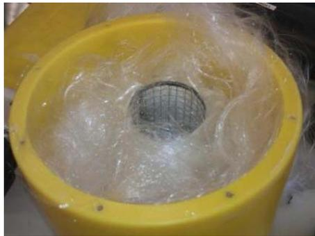
Figura 4.47. Prototipo de silenciador disipativo.
