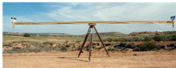
Fig. 6. Corobate, instrumento para el trazado de túneles.
