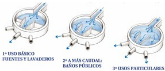
Figura 22. Funcionamiento de un partididor. Fuente: Feijoo, 2006
