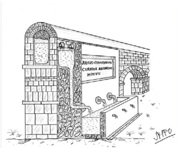
Figura 26.Fuente aliviadero típica romana. Fuente: De la Peña, 2010
