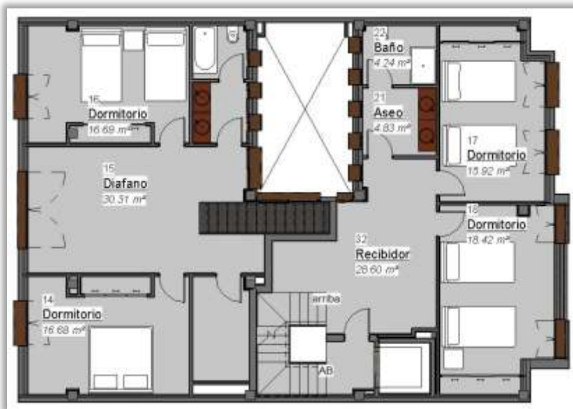
Figura 0.71. Ejemplo planta 2ª edificio en LOD 300
