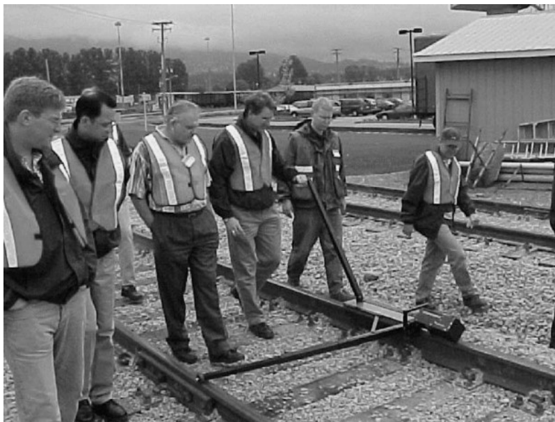
Figura 83: Uso de la primera versión del Triborailer, empujado a mano [50].
