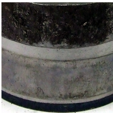
Figura 141.- Aspecto visual de los discos ensayados con agua a 1384.7 MPa y un 2% de deslizamiento.
