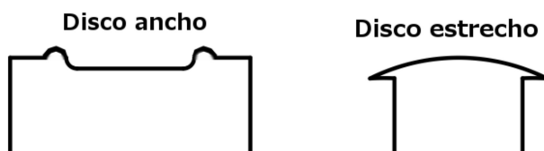
Figura 125.- Cambios geométricos en los discos tras los ensayos. Se ha exagerado enormemente la elevación de material que rodea el carril de rodadura en el disco ancho debido a la deformación plástica.
