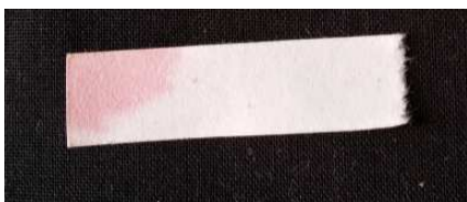
Imagen 34: Medición presencia de tinta ferrogálica Imagen 35: Testigo coloreado
