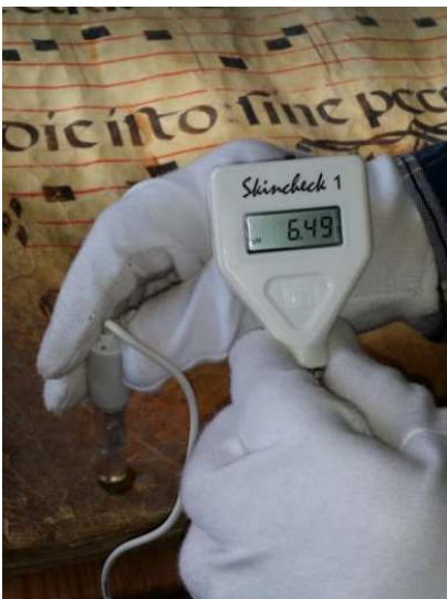
Imagen 31: Medición del grosor del soporte Imagen 32: Medición del pH del soporte
