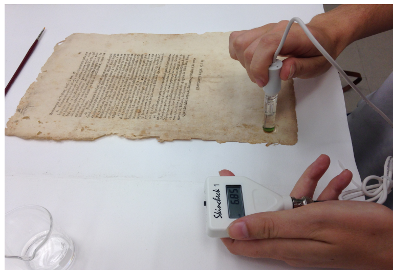
Figura 20. Documento 1. Depósito de una gota de agua destilada antes de proceder a la medición del pH. Foto: Evelien Van den Heuvel.
