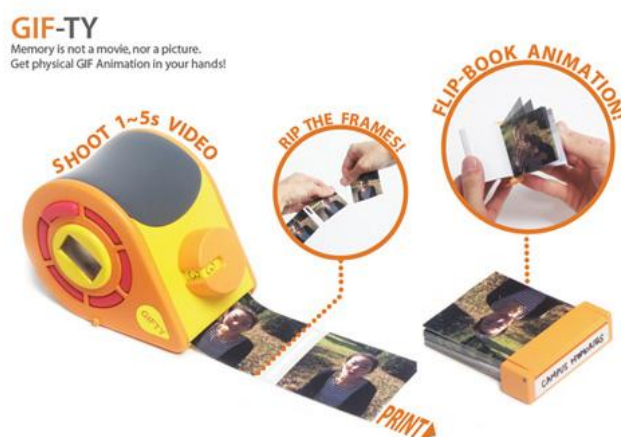
Fig. 264: La cámara Gif-ty permite grabar una serie de imágenes consecutivas e imprimirlas en una impresora integrada en ella. A continuación, los fotogramas se cortan y se montan en un flip-book (imagen tomada en http://dornob.com/ ).
