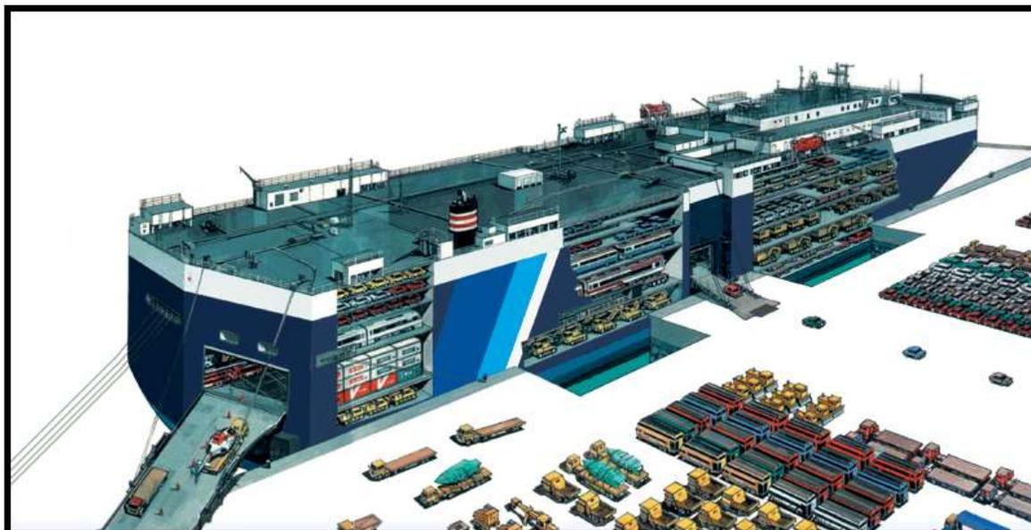
Ilustración 10, Buque Ro/Ro, (<http://razonyfuerza.mforos.com/549911/10423143-buques-de-proyeccion-de-la-armada-iv/?pag=24> )
