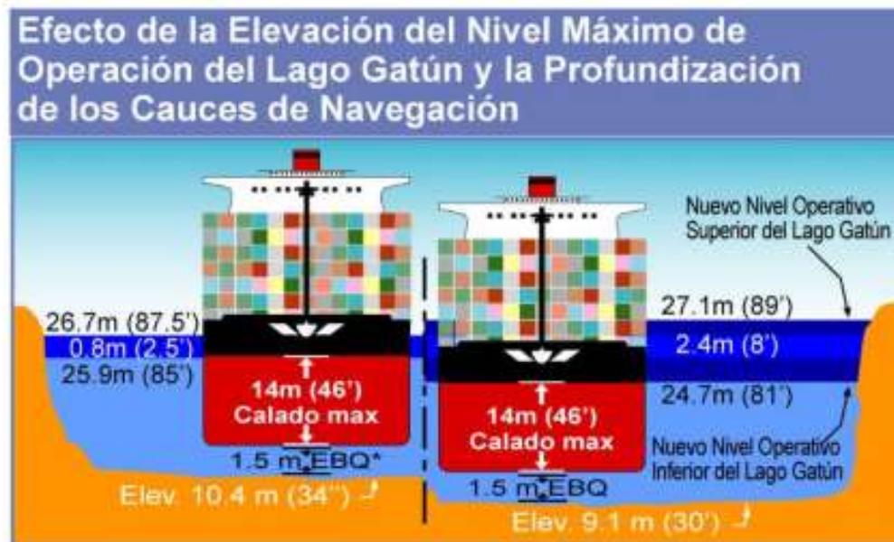
Ilustración 25, Efecto de elevación del lago Gatún, (ACP, Plan Maestro, 2006)
