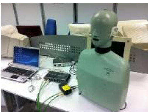
I.3.4.A- Sistema de grabación binaural y sistema de 96 altavoces diseñado por J. J. LÓPEZ, sala de Wave Field Synthesis , iTeAM, Ciudad Politécnica de la Innovación (CPI) UPV.
