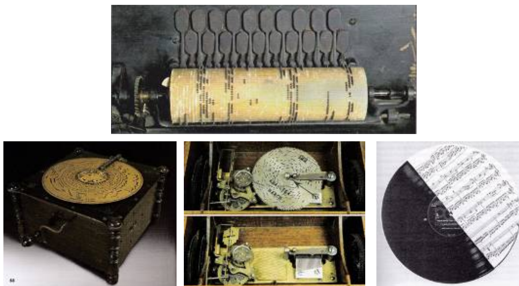
I.4.1.G- Fotografías del mecanismo con rodillos de cera de un Órgano Gem Roller , sistema neumático de discos perforados, interior de una Caja de música Edelweiss con sus discos de metal y Lisztén (1986) de Stuart SHERMAN.
