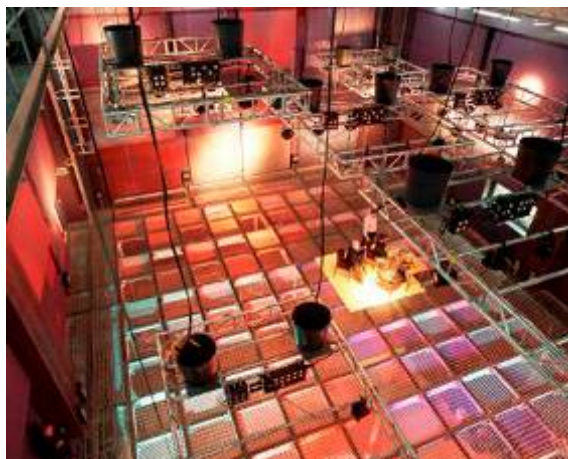
I.3.1.N- Bocetos del Sound Cube (1969) de LEITNER, fotografía y esquema del Sonic Laboratory del S.A.R.C., en la foto se puede apreciar el suelo acústicamente transparente.
