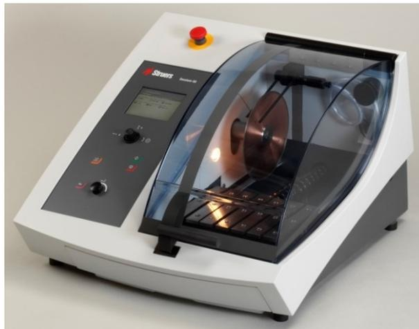
**Figura 4.8** Cortadora automática de precisión (*Instituto de tecnología de materiales UPV*)
