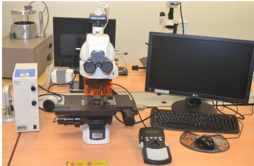
**Figura 4.12** Microscopio óptico de mesa electrónica y cambio de lente automático (*Instituto de Tecnología de Materiales UPV*)
