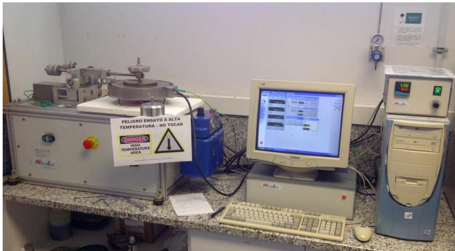
**Figura 4.27** Tribómetro de alta temperatura en configuración bola sobre disco (Instituto de tecnología de materiales UPV)
