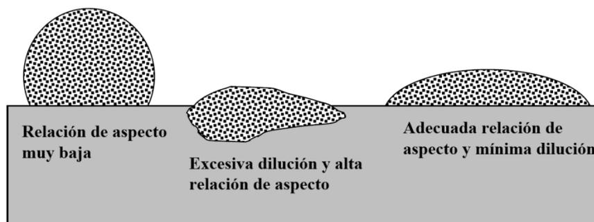
**Figura 3.6** Diferentes relaciones de aspecto y dilución obtenidas con diferentes parámetros de procesado láser
