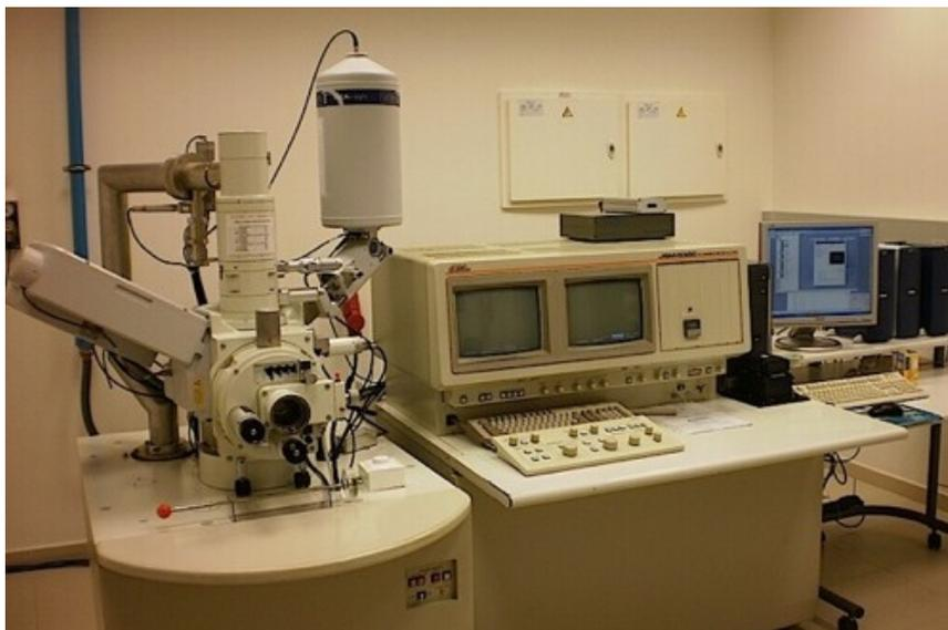
**Figura 4.3** Microscopio electrónico de barrido de electrones (*Servicio de microscopía UPV*)
