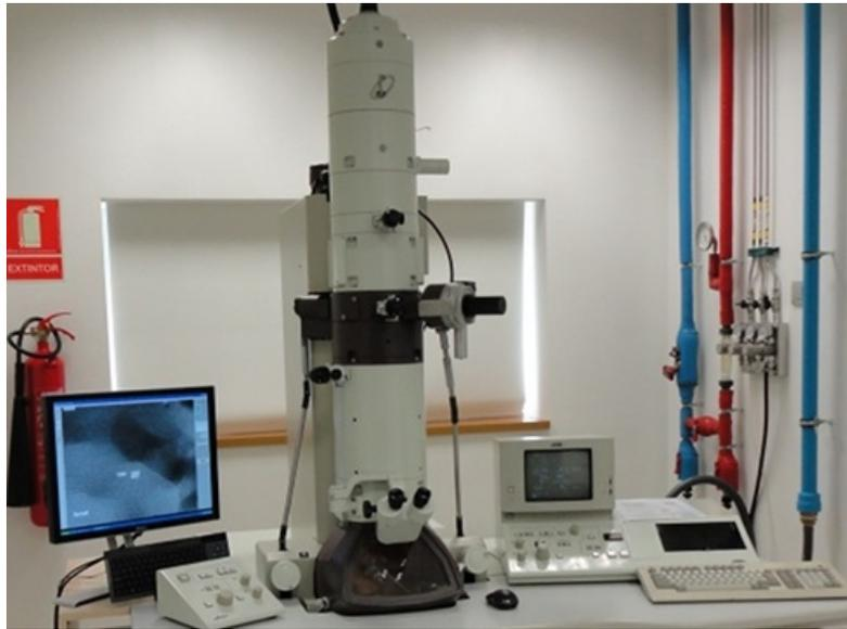
**Figura 4.15** Microscopio electrónico de transmisión de 100 kV (*Servicio de microscopía UPV*)
