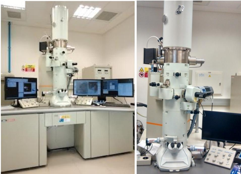
**Figura 4.16** Microscopio electrónico de transmisión de 200 kV (*Servicio de microscopía UPV*)
