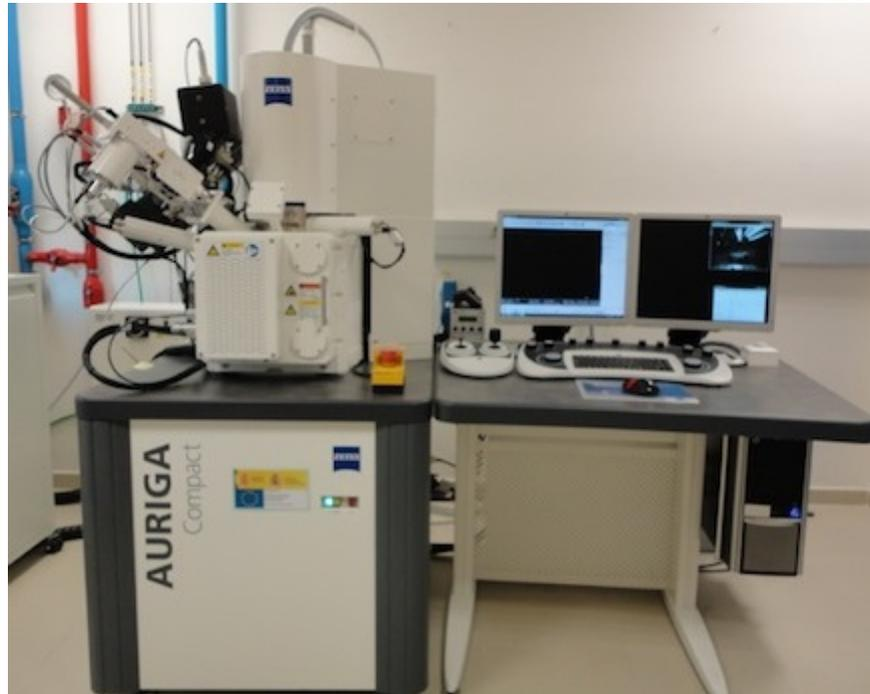
**Figura 4.14** Microscopio electrónico de barrido de emisión de campo con cañón de iones de Galio (Servicio de microscopía UPV)
