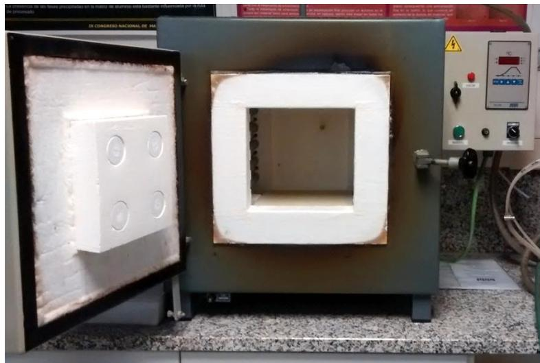
**Figura 4.23** Horno de atmosfera controlada utilizado para los ensayos de oxidación isotérmica (Instituto de Tecnología de Materiales UPV)
