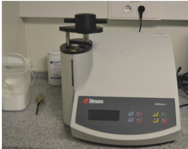
**Figura 4.9** Embutidora automática de muestras (*Instituto de tecnología de materiales UPV*)
