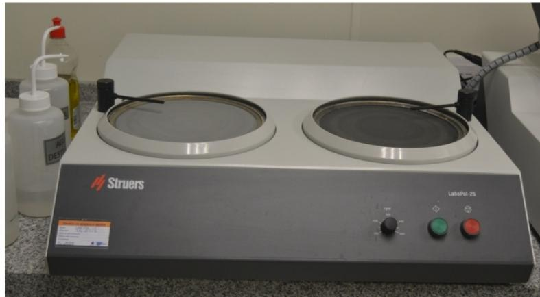
**Figura 4.10** Desbastadora de discos de velocidad variable (*Instituto de tecnología de materiales UPV*)
