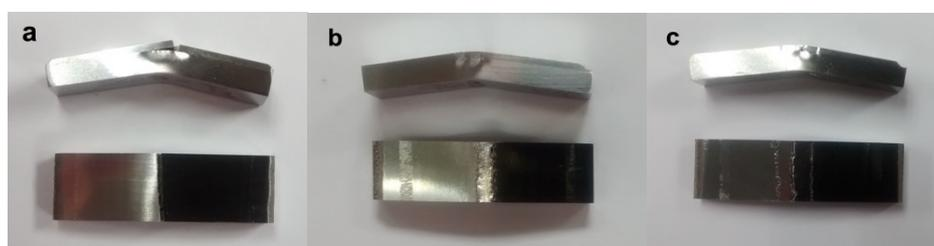
**Figura 5.19** Imágenes de la sección transversal de la zona de fallo del recubrimiento con orientación transversal **a)** Recubrimiento NiCoCrAlY **b)** Recubrimiento NiCrAlY y **c)** Recubrimiento CoNiCrAlY
