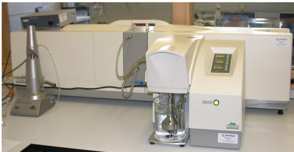
**Figura 4.1** Difractómetro láser Malvern Instruments© (*Instituto de tecnología de materiales UPV*)
