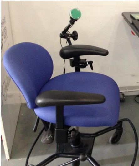
Ilustración 5 – Silla adaptada (botón verde de control por toques) “Ilusión” 25 aniversario Fundación ONCE Oct.2013 Fuente: ONCE
