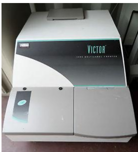
Figura 10. Espectrofotómetro de placas utilizado en la medida de la absorbancia del extracto de IgEs cuantificado mediante el método ELISA
