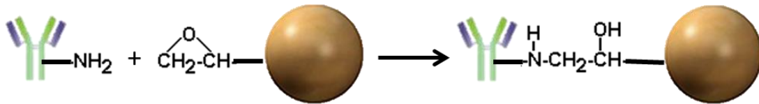
Figura 21. Reacción de conjugación entre los grupos amino de los anticuerpos anti-IgEs y los grupos epoxi de las partículas magnéticas.
