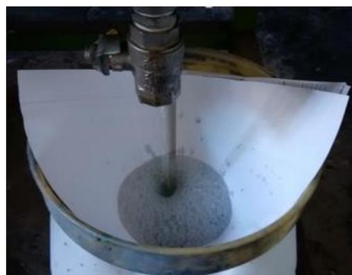
*Ilustración 8. Filtrando las disoluciones con papel de filtro*
