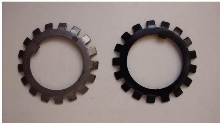
*Ilustración 15. Pieza antes y después del pavonado*
