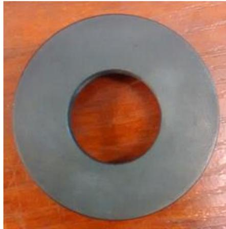
*Ilustración 14. Pieza con un pavonado uniforme*
