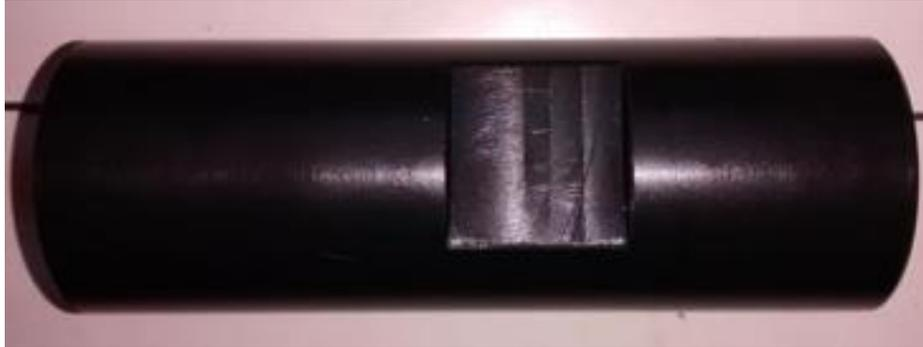
*Ilustración 17. Pieza uniformemente pavonada*
