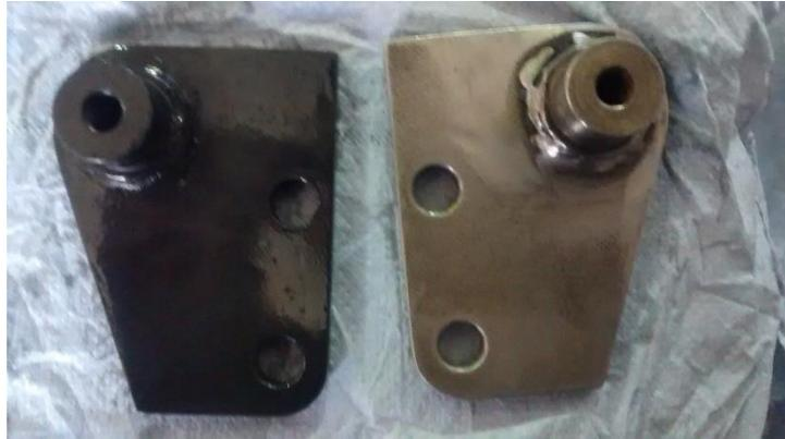
*Ilustración 22. Misma pieza pavonada y sin pavonar.*
