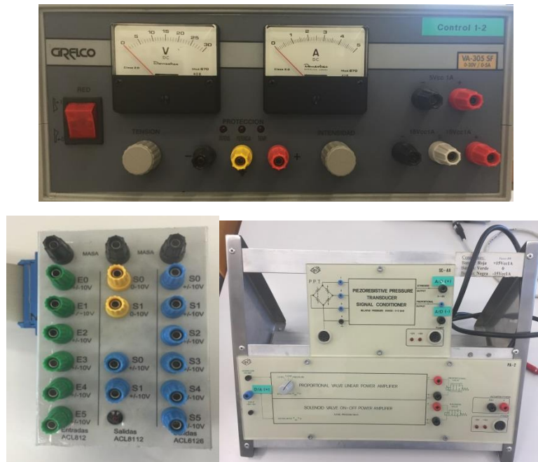
Figura 2. Fuente de alimentación (arriba), Tarjeta de adquisición de datos (izquierda) y Panel de control (derecha)
