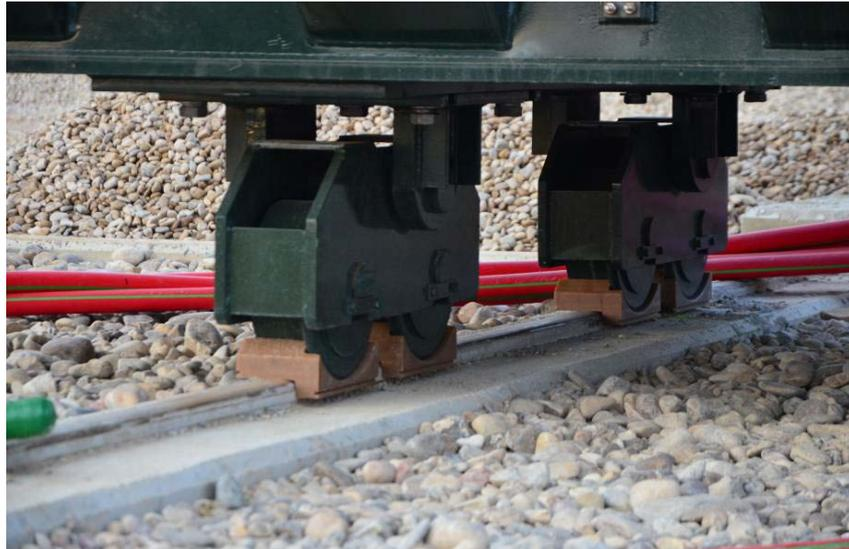
Imagen 52: detalle de las ruedas de los transformadores sobre el raíl.
