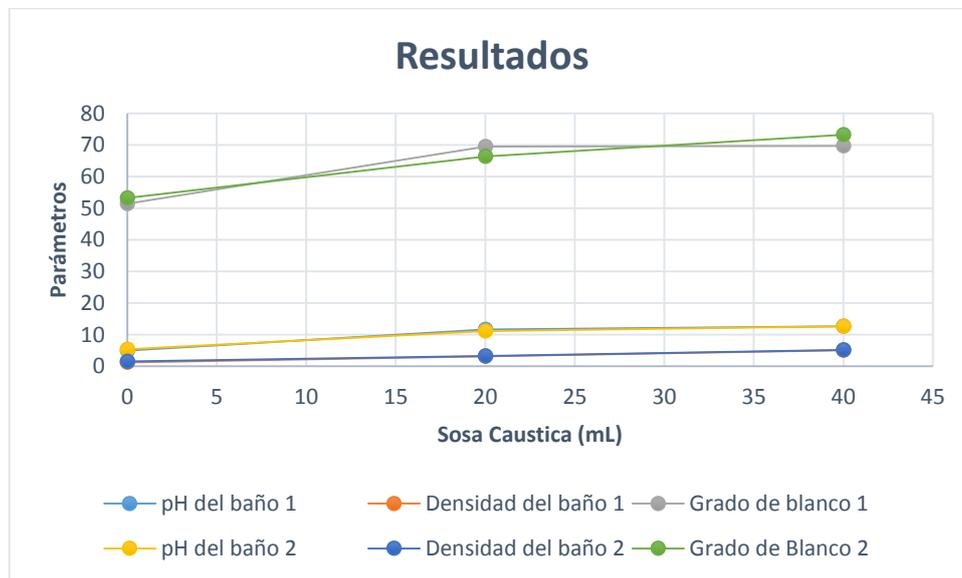
Figura 7. Resultados Pruebas 1 y 2 Impregnación. Análisis Sosa Caustica
