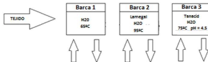
Figura 5. Lavado de tintura en laboratorio
