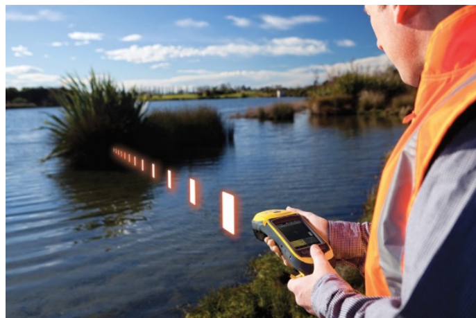
Figura 18. DMP con distanciómetro láser
