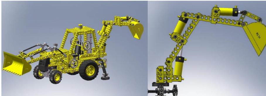
Fig. 24. Detalle del mecanismo plano de la pala trasera del modelo 8862-1.
