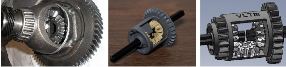
Figura 3. Diferencial real, diferencial Lego® Technic y diferencial Lego® Technic virtual (2007, El hilo de mecánica de PabloGTD) (MercadoLivre)
