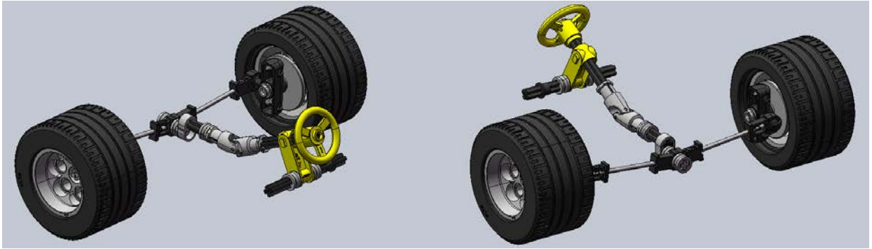
Figura 32. Mecanismo de dirección del modelo 8445-2 en dos vistas
