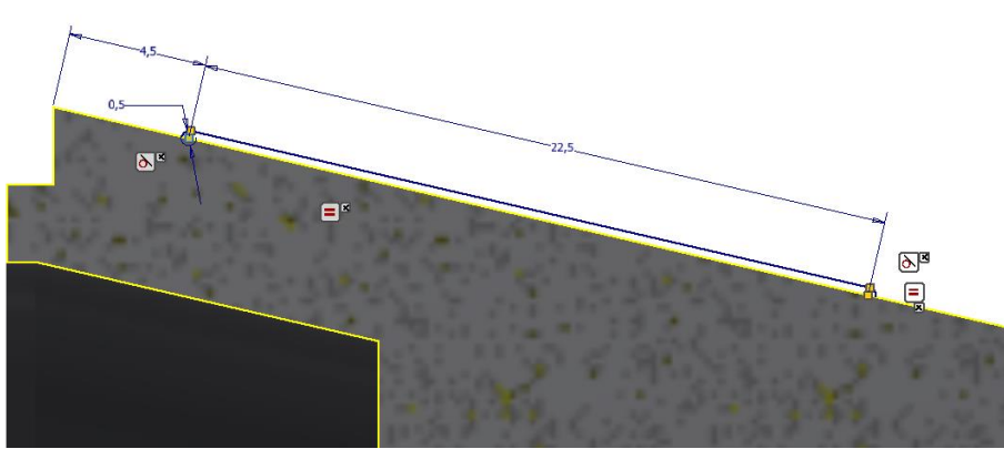
Figura 3.26: Boceto para los relieves del rodillo bi-cónico
