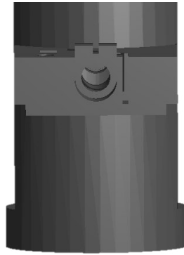
Ilustración 3.11- Vista agujero pasante de una cámara de turbidostato
