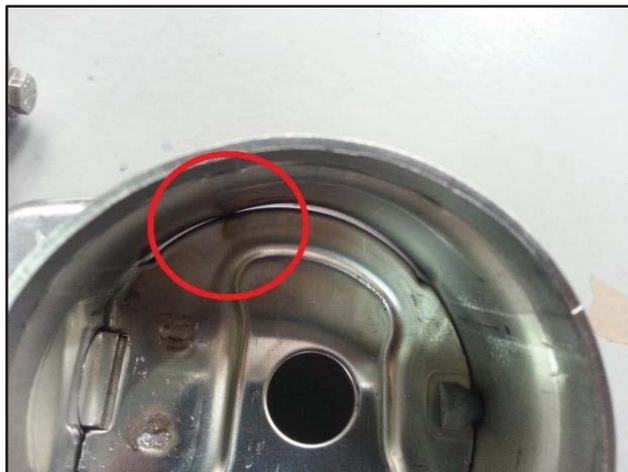
**Ilustración 54: *Valve housing* deformado por soldadura con electrodo re-trabajado a 4.7mm y montado al revés**
