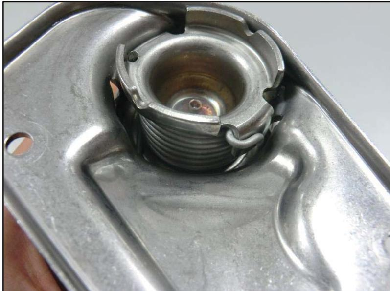
Ilustración 69: Espacio entre *coupling disc lower* y *motor bracket upper*
