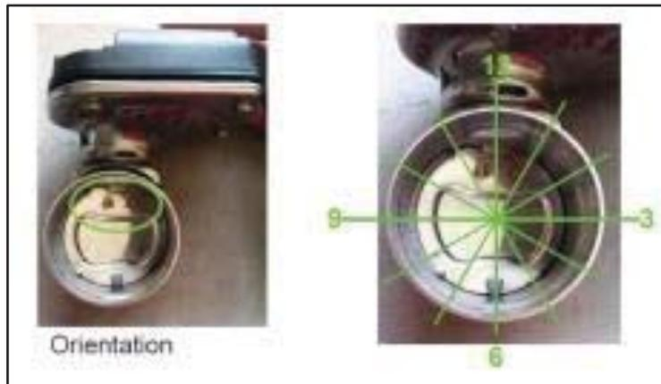
Ilustración 43: Puntos de contacto del disco con el casquillo
