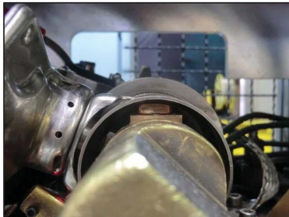
Ilustración 52: Electrodo herramienta 3 con valve housing en posición de soldadura
