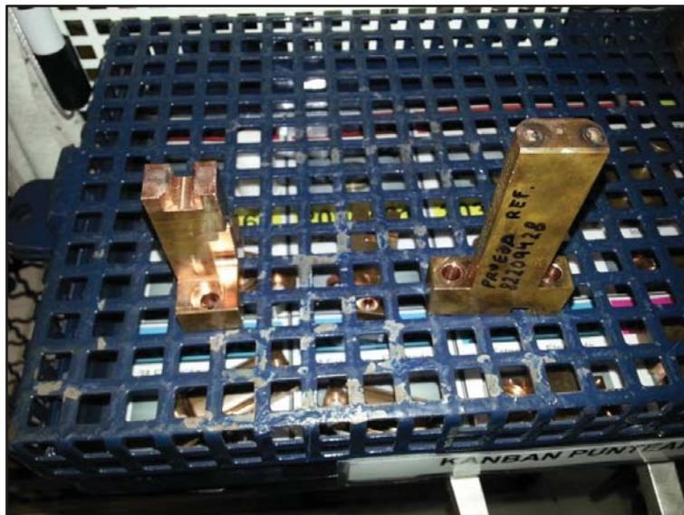
Ilustración 76: Izquierda electrodo inferior, derecha electrodo superior de la estación 4
