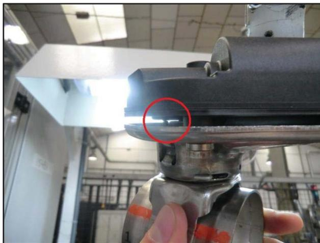
Ilustración 70: Coupling disc lower rascando con el actuador
