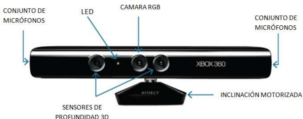
Figura 4. Partes de Kinect (Imagen obtenida de http://blog.robotiq.com/ )
