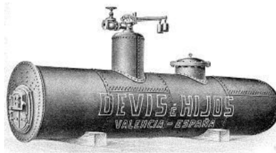
Figura 4.3. Caldera "Cornish" taller Devis e hijos. Fuente: archivo de Vossloh España S.A.
