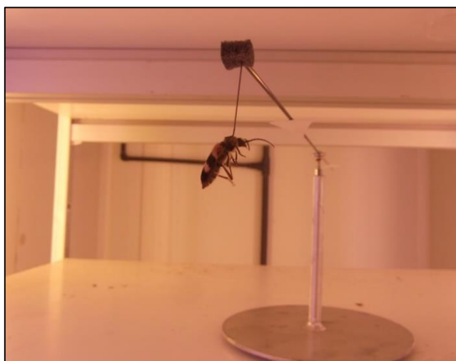
Figura 8: Detalle de la fijación del insecto al molinillo de vuelo.
