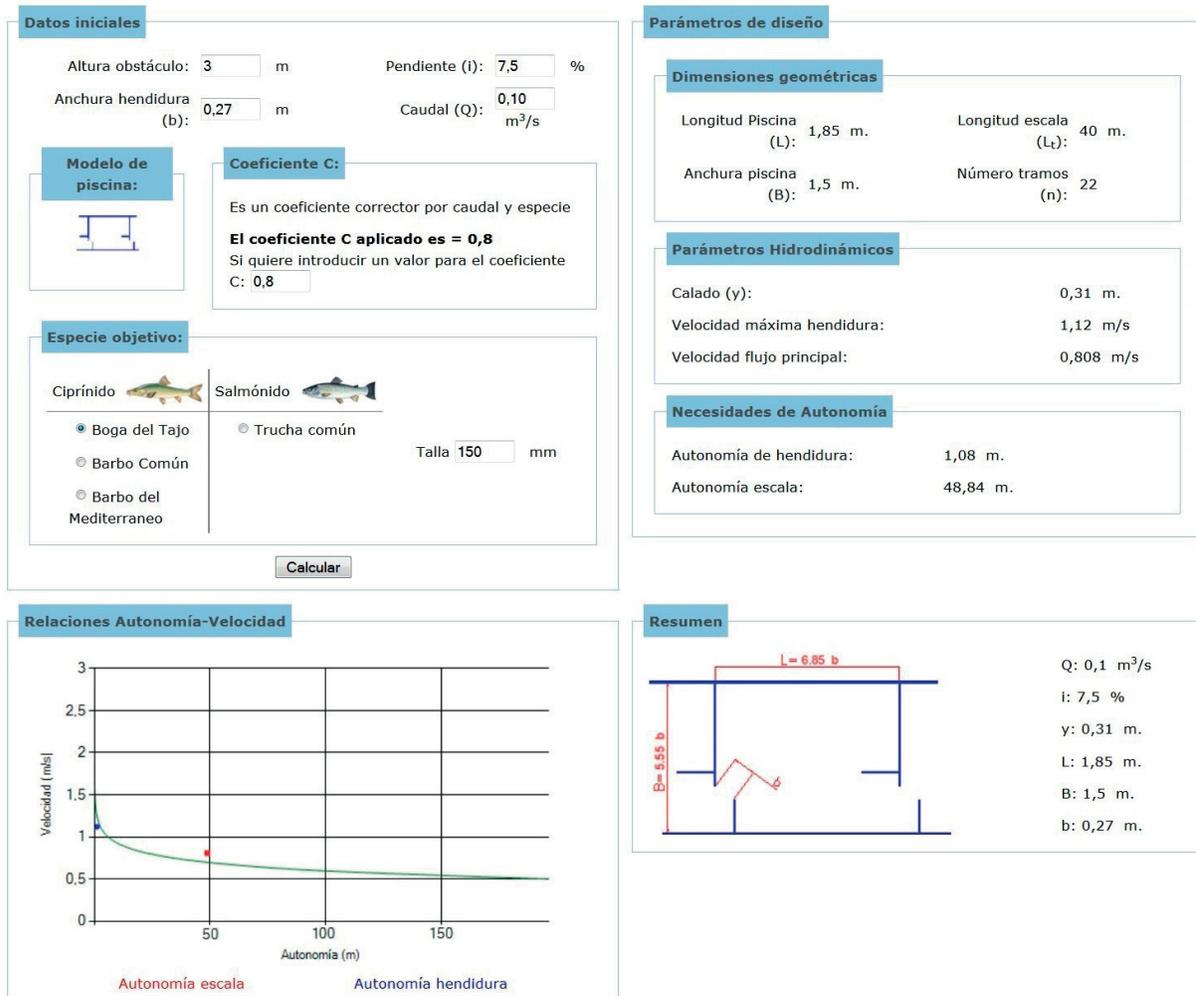
**Figura 4 |** Ejemplo de salida de la aplicación en la primera pestaña. En este caso el diseño no es adecuado para la especie y talla objetivo, se incumple la restricción IV.
