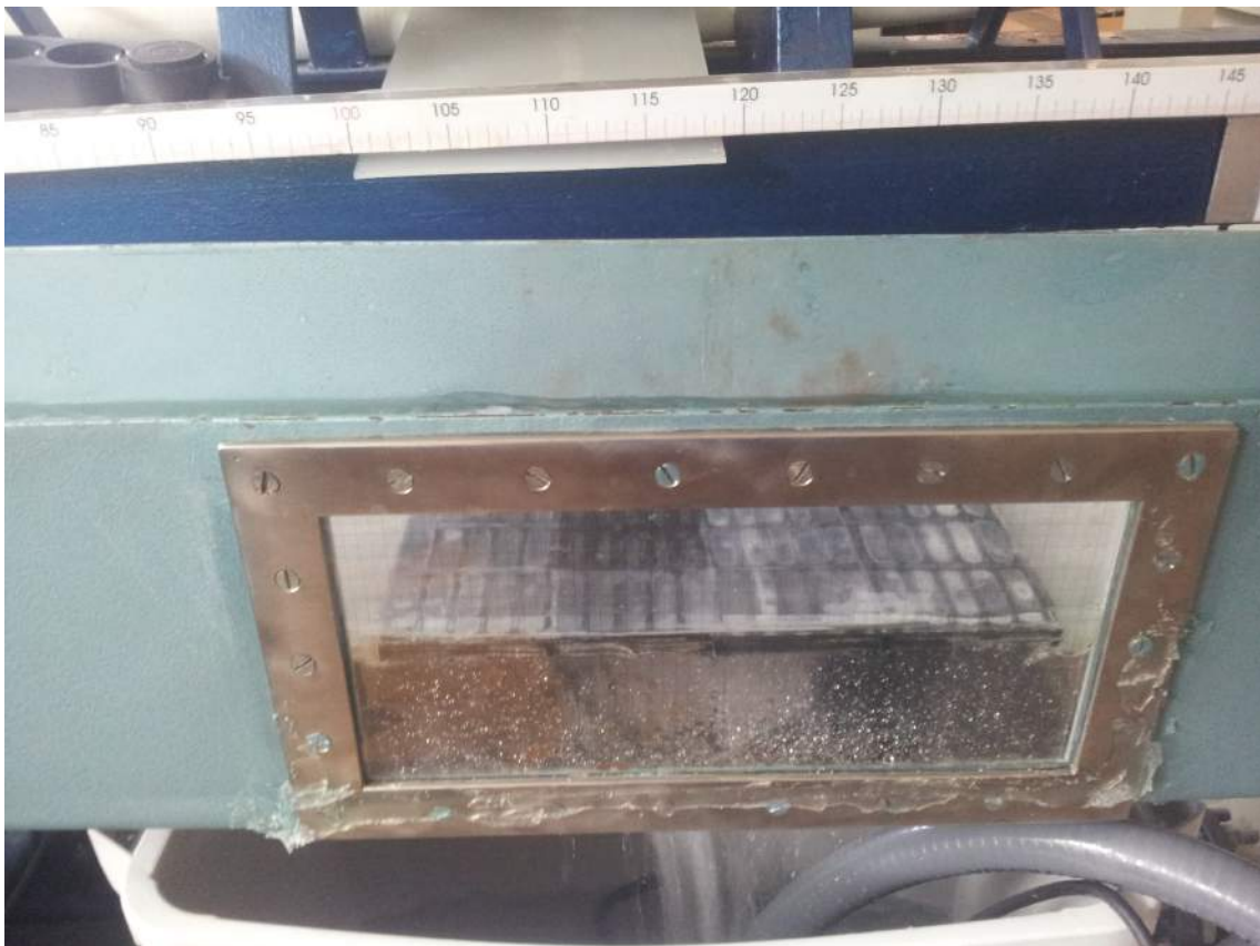
Figura 19. Cristal por el que vamos a poder observar el flujo a través de la rejilla.
