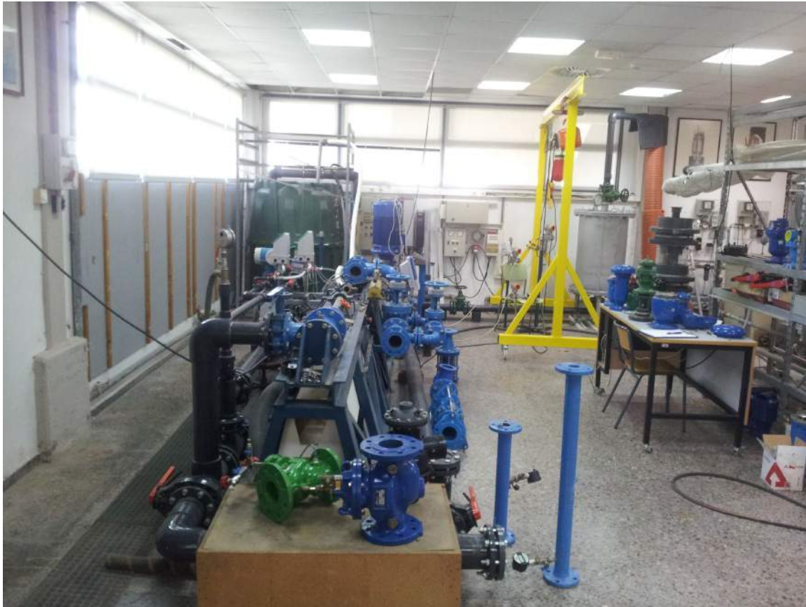
Figura 33. Banco de ensayo para el error del caudalímetro.
