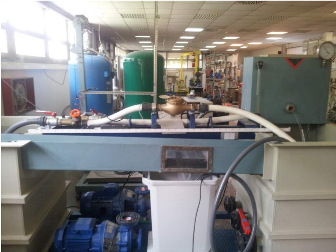
Figura 18. Banco de ensayos dónde se testará nuestro imbornal.
