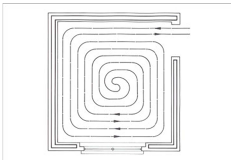
Suelo radiante en espiral (Fuente: Eurocable).
