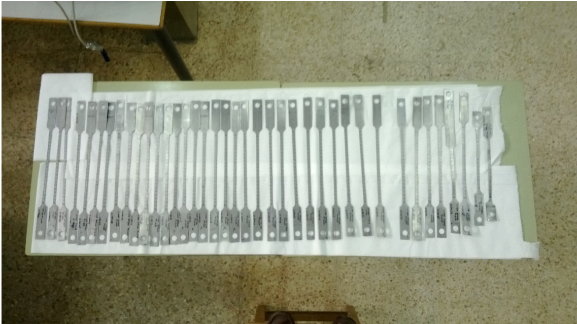
Fig. 35. Preparación de las probetas antes de realizar los ensayos.
