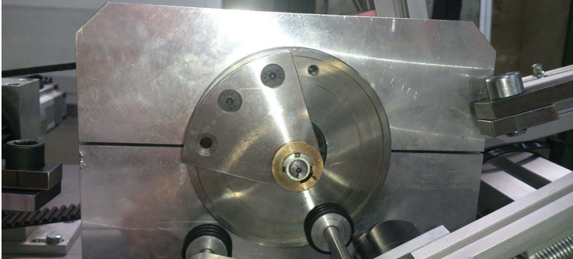
Fig. 25. Apoyo del pin rebajado.
