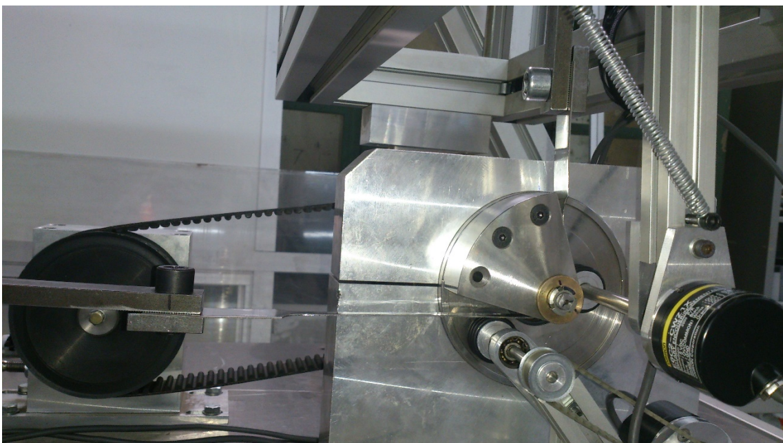
Fig. 36. Colocación de la probeta para realizar el ensayo.
