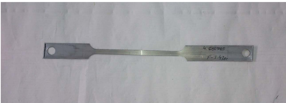
Fig. 30. Nueva probeta con dimensiones de 400 x 25 mm.
