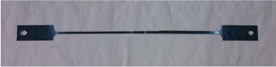
Fig. 14. Probetas antiguas con medidas de 800 x 50 mm.
