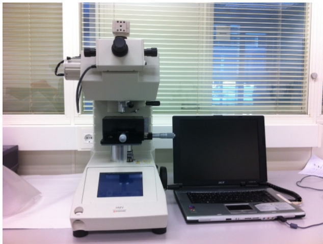
Figura 3.11. Microdurómetro Shimadzu Modelo HMV-2 con microscopio integrado utilizado para los ensayos de dureza Vickers y tenacidad por microindentación conectado a ordenador.
